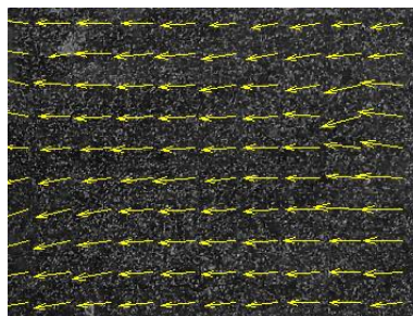
Figura 6.9: Campo de vectores del vídeo 2 (antes de llegar al obstáculo), flujo laminar rectilíneo. Fuente [Autor].
