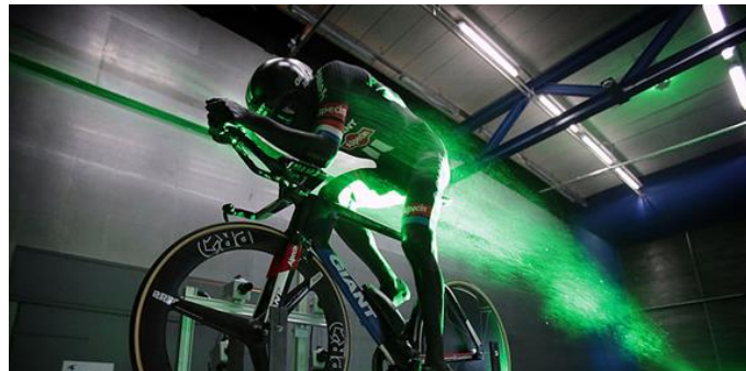
Figura 1.6: Estudio del flujo para mejorar aerodinámica sobre la bicicleta. Fuente [ www.dantecdynamics.com-piv-application-examples ].
