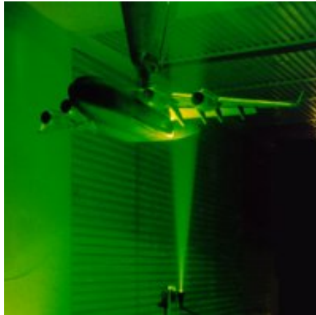
Figura 1.5: Estudio aerodinámico de una maqueta de avión mediante PIV. Fuente [ www.dantecdynamics.com-piv-application-examples ].
