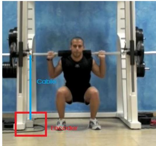
*Ilustración 3:Encoder lineal*
