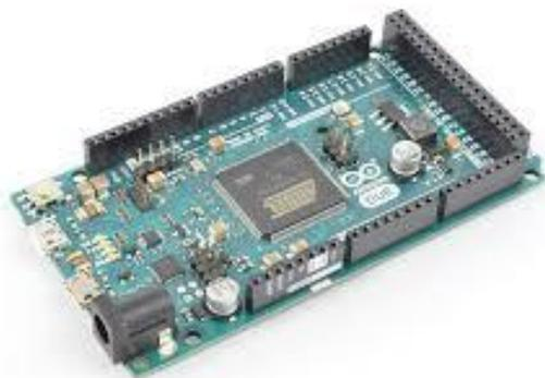
*Ilustración 15 Arduino DUE*
