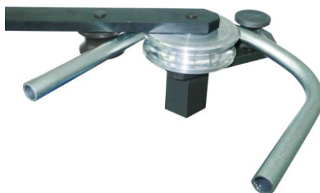
Ilustración 198. Curvado y doblado de tubos
