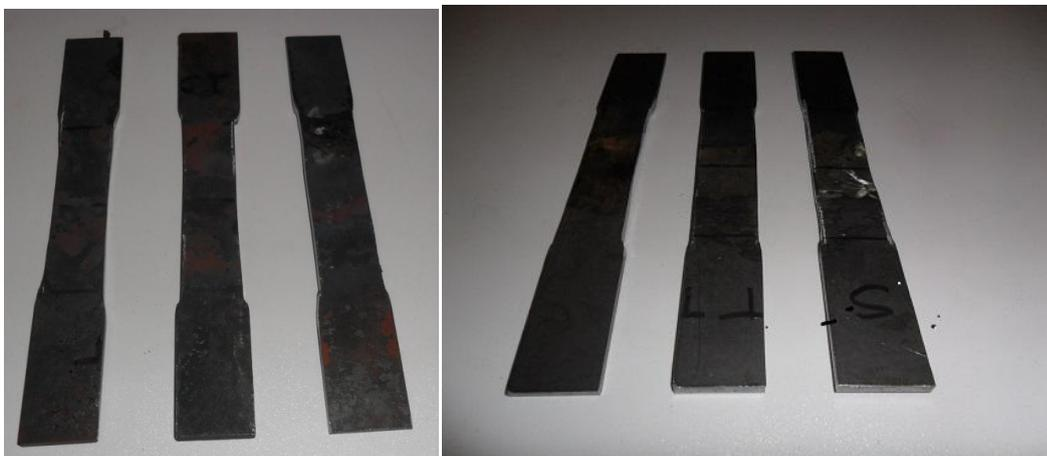
**PROBETAS PARA EL ENSAYO DE TRACCIÓN**
