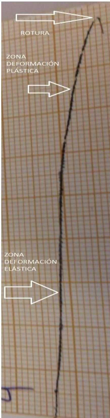
Podemos observar en la graficas de resultados, las diferenciaciones de las zonas que componen la curva tensión-deformación para el acero.
