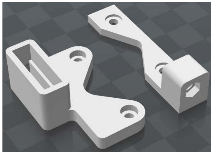
Figura 43. Model 3D del suport del final de cursa de l'eix Z. Font: pròpia.
