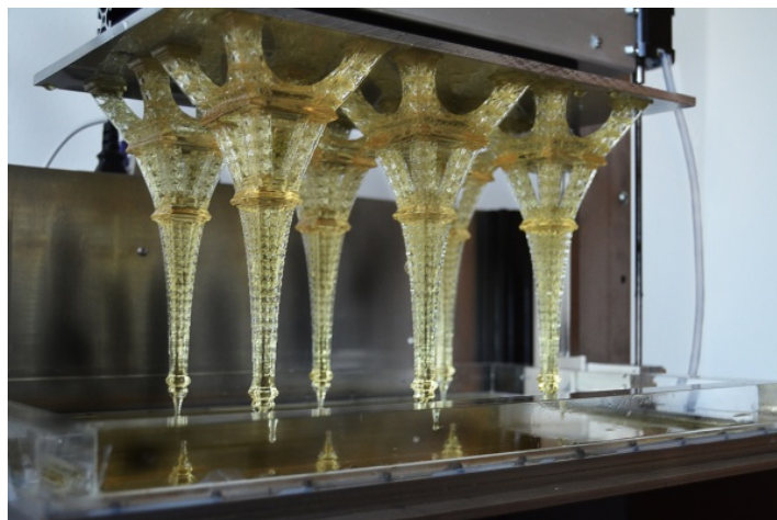
Figura 2. Peces impreses per estereolitografia en una impressora comercial. Actualment, algunes impressores imprimeixen les peces col·locant-les a l'inrevés i elevant poc a poc la plataforma. Font: http://www.3ders.org/images/Solidator_SixEiffelTowers.jpg
