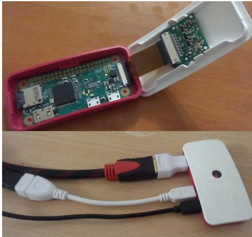
Figura 61. Raspberry Pi Zero W en la carcassa amb la càmera i les connexions. Font: pròpia
