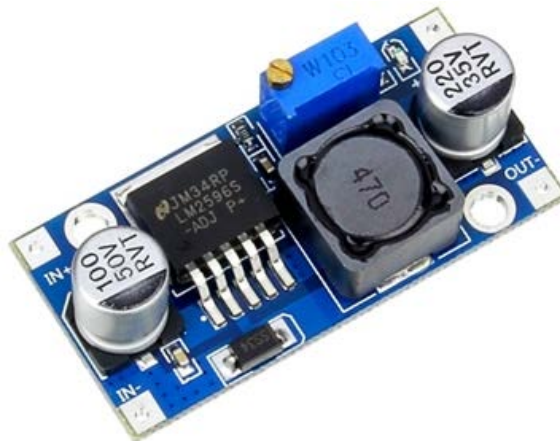
Figura 71. Regulador de voltatge LM2596. Font: https://www.addicore.com/lm2596-module-p/ad281.htm
