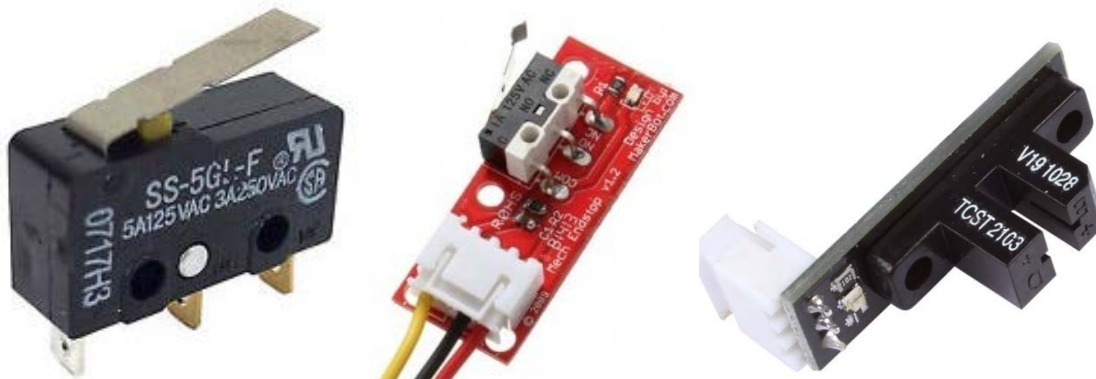
Figura 31. Diferents tipus de final de cursa: mecànic, mecànic en placa integrada i òptic. Fonts: https://www.staticboards.es/blog/marlin-instalacion-configuracion/ , https://articulo.mercadolibre.com.co/MCO-453259932-final-de-carrera-impresora-3d-prusa-marlin-hephestos-_JM , https://electronilab.co/tienda/interruptor-final-carrera-optico-cnc-impresora-3d/
