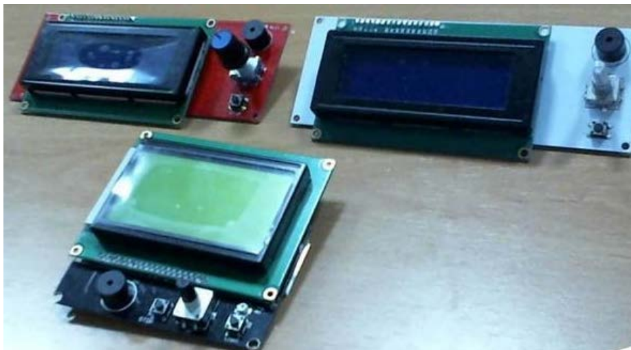
Figura 38. Diferents tipus de pantalles LCD. Font: https://www.zonamaker.com/impresion-3d/mejoras-trucos-y-consejos/pantalla-lcd
