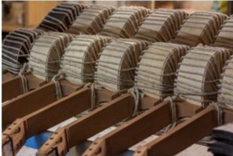
Fig. 22: Secado de la caja armónica tras el encolado de sus elementos.
