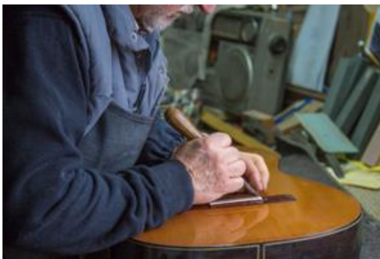
Fig. 24: Últimos acabados en el puente.
