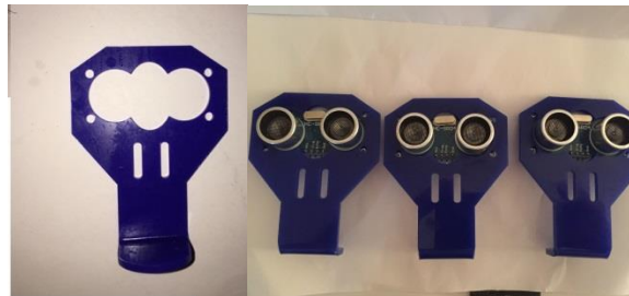
IMAGEN 72: SENSORES HC-04 ACOPLADOS A LOS SOPORTES
