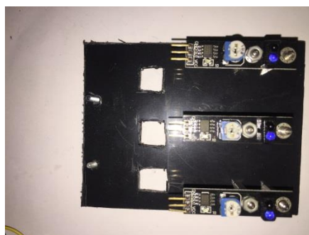
IMAGEN 61: SENSORES TCRT500 MONTADOS EN SOPORTE
