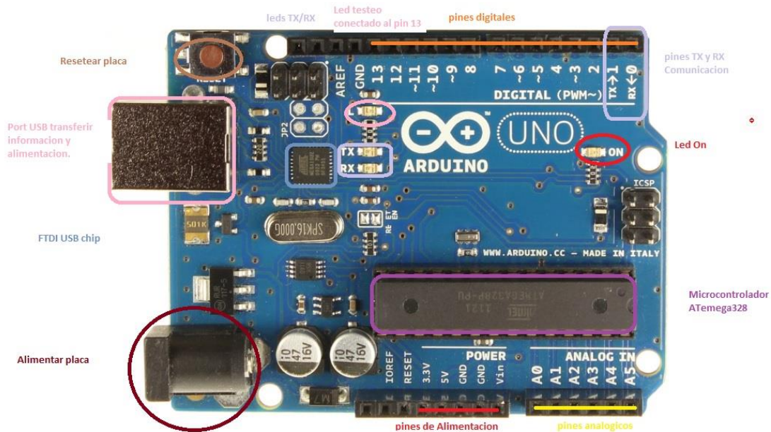
ILUSTRACIÓN 4: PINES TARJETA ARDUINO UNO
