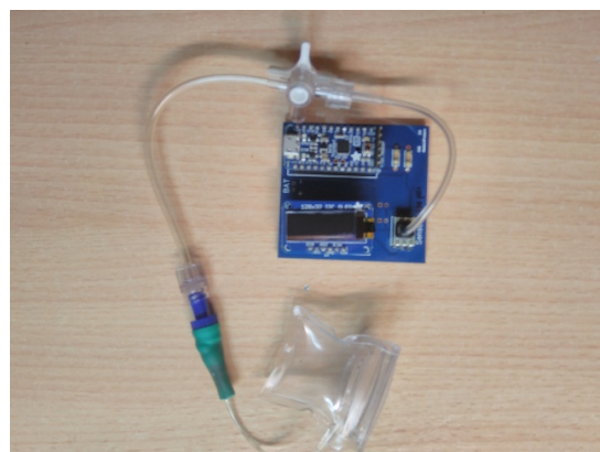
Fig 50: Trasmisión de presión al sensor completo
