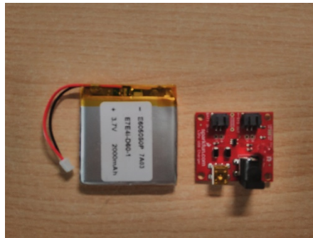
Fig 44: Batería y módulo de carga
