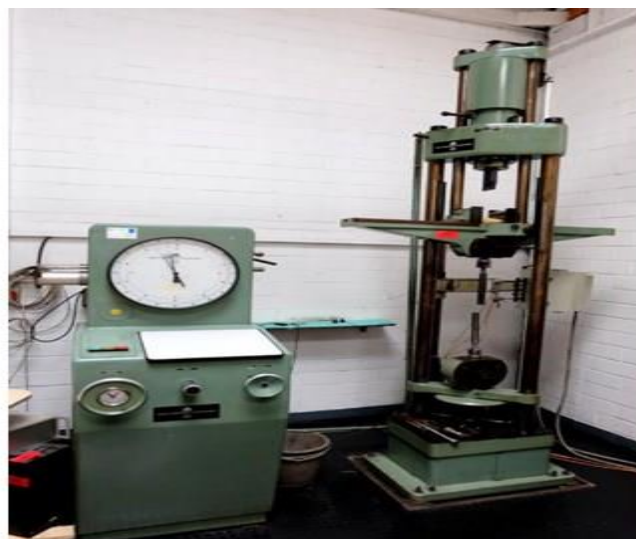
Ilustración 16. Maquina universal de tracción MOHR & FEDERHAFF
