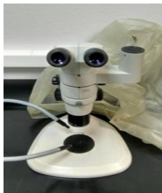
Ilustración 33. Microscopio estereoscópico NIKON SMZ800
