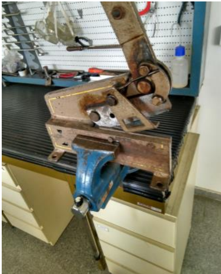
Ilustración 14. Cizalla acoplada en tornillo de banco
