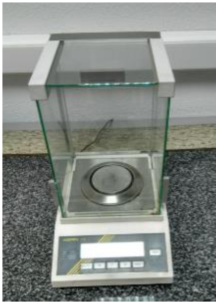
Ilustración 32. Báscula de precisión KERN 770
