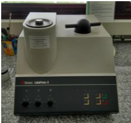
Ilustración 19. Máquina de embutición y compuesto termoendurecible
