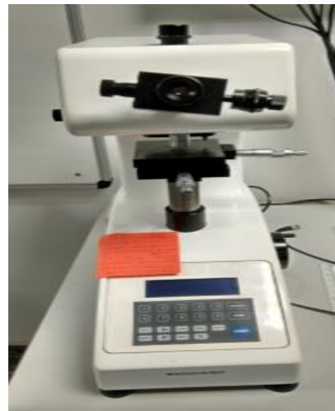
Ilustración 27. Máquina para ensayo de dureza INNOVATEST
