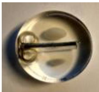
Ilustración 20. Cubilete resultante de la embutición
