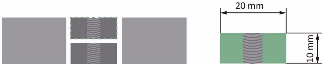
Ilustración 17. Ejemplo de la muestra tomada para micrografía
