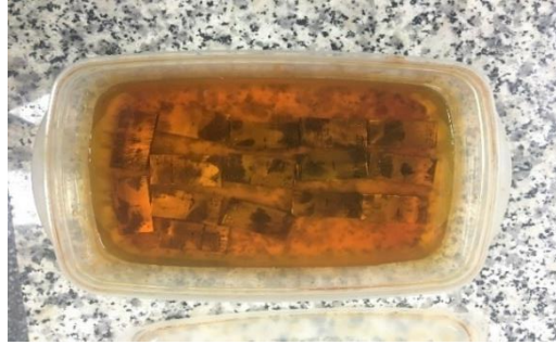
Ilustración 28. Probetas sumergidas en Cloruro Férrico
