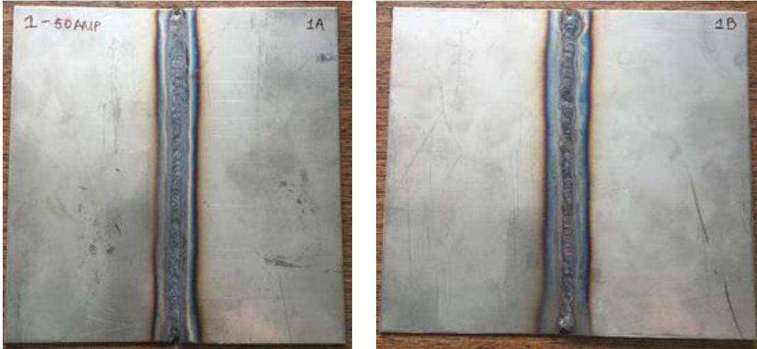
Ilustración 13. Resultado final de las chapas soldadas
