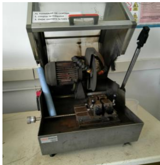
Ilustración 18. Sierra de disco con accionamiento manual
