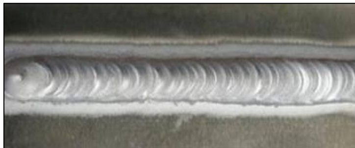
Ilustración 9. Cordón de soldadura
