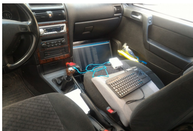
Il·lustració 28: Raspberry Pi i monitor instal·lats a l'interior del cotxe.
