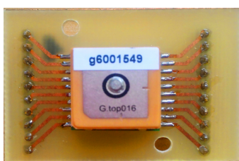
Il·lustració 17: Planta i perfil del receptor instal·lat a la PCB
