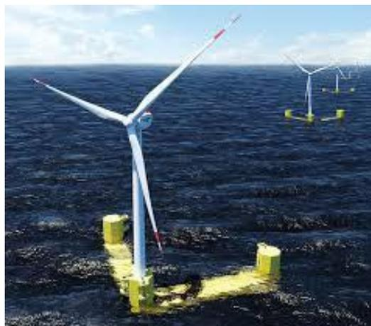
Figura 35. Plataforma semisumergida. Fuente: [www.seaplace.es](http://www.seaplace.es)
