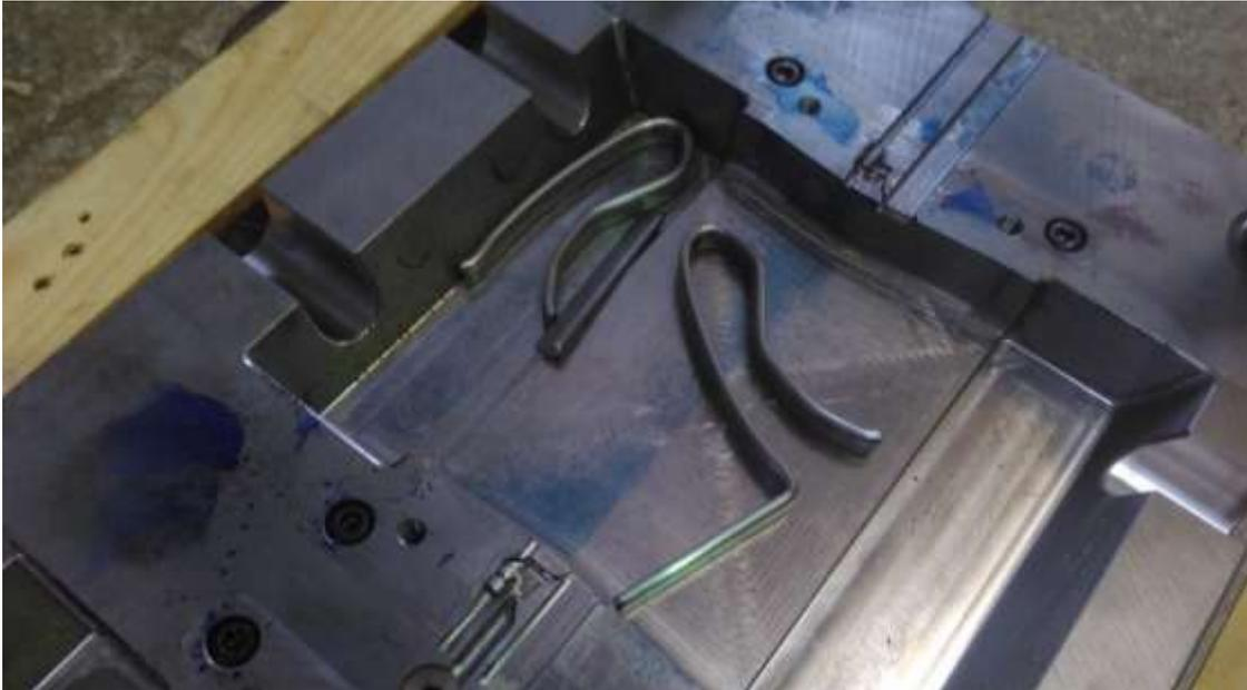
*Figura 8.1. Varillas dobladas y fracturadas sobre la hembra del molde.*
