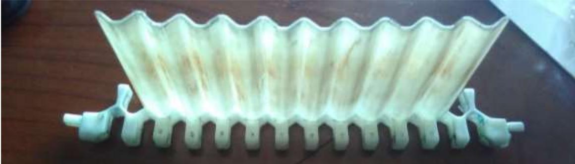
*Figura 8.2. Piezas resultantes de la primera inyección del molde.*
