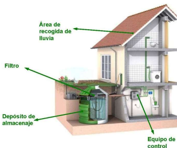
Figura 8. Sistema de recolección de pluviales. Fuente: www.laenergiarenovable.es .
