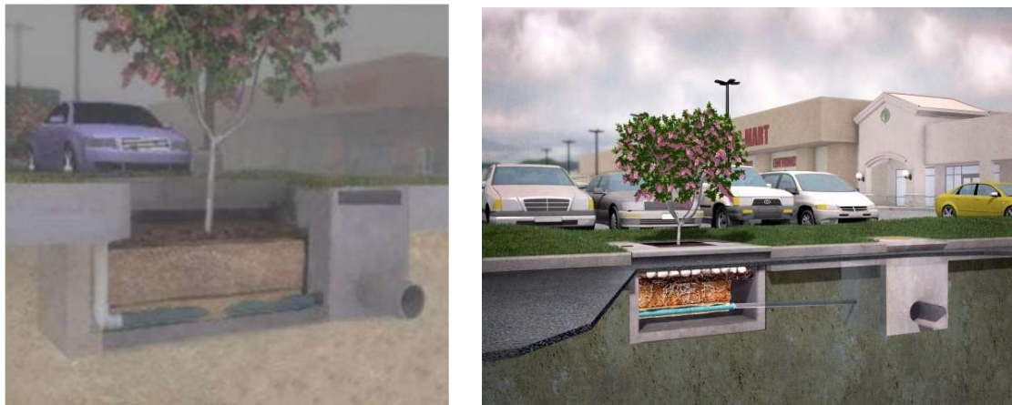
Figura 86. Sumidero tipo alcorque inundable. Fuente: www.conteches.com .
