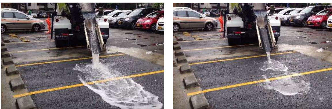
Figura 76. Ensayo de permeabilidad de un pavimento permeable asfáltico. Fuente: Productora y comercializadora de cemento y concreto Argos.
