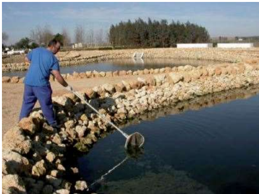
Figura 103. Retirada de flotantes en una laguna de maduración. Fuente: Vicente Javier Macián.
