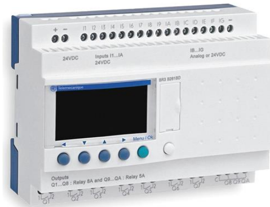
Imagen 3. Relé inteligente modular Zelio Logic modelo SR3B261BD. (Disponible en: http://www.schneider-electric.us/en/product/SR3B261BD/modular-smart-relay-zelio-logic---26-i-o---24-v-dc---clock---display/ ).
