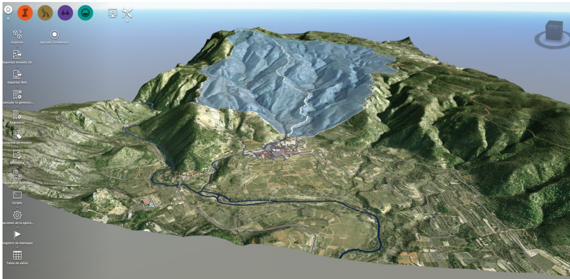
Imagen32. Cuencas vertientes y cauce. Infracworks.Fuente: Elaboración propia
