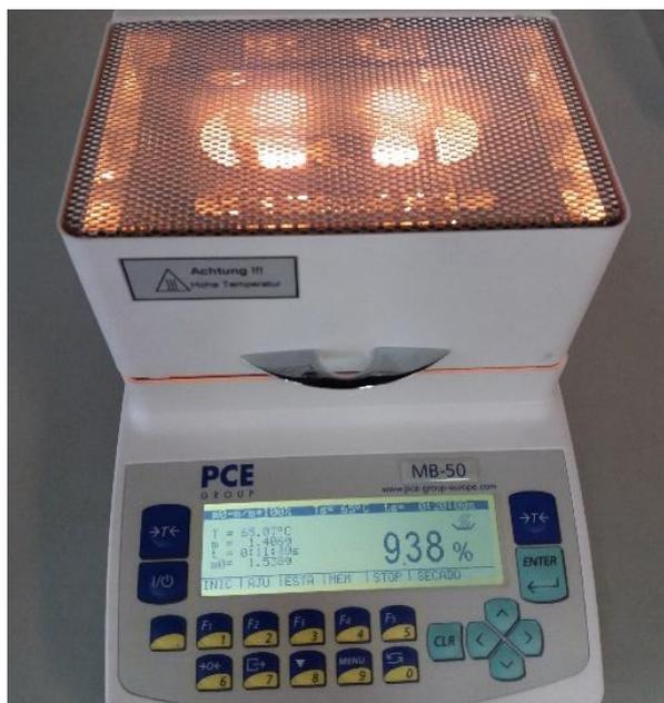
Ilustración 28. Balanza de medición de humedad.
