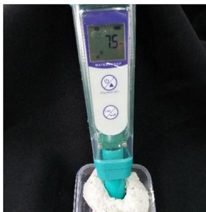
Ilustraciones 44 y 45. Medición de pH en húmedo de los elementos y de una masilla con cartón (CAA 4.1)
