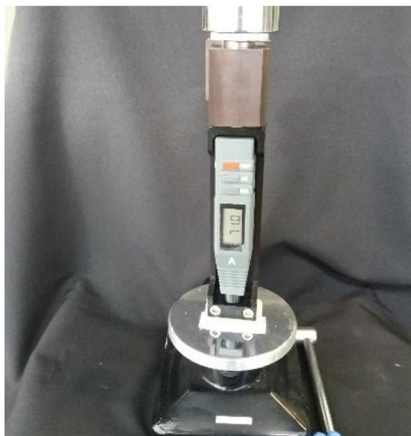
Ilustración 29. Medición de dureza
