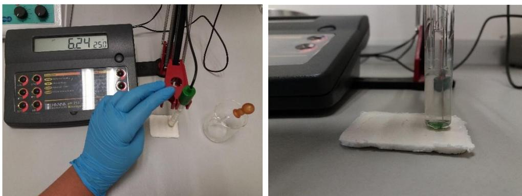
Ilustraciones 31 y 32. Medición de pH en seco con pH-metro modelo pH 123 de la casa HANNA instruments
