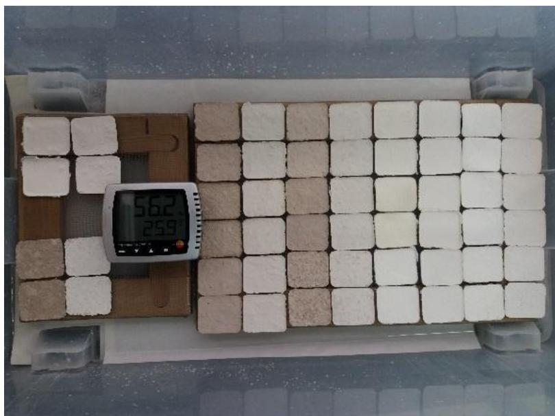
Ilustración 27. Cámara de humedad
