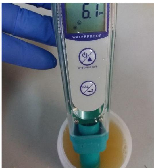
Ilustración 30. Medición de pH en húmedo con pH-metro digital XS IP 67 (G-PHT1ECO)
