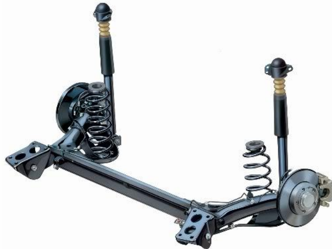
Figura 20. Suspensión de eje torsional. ( www.senseikoche.com )
