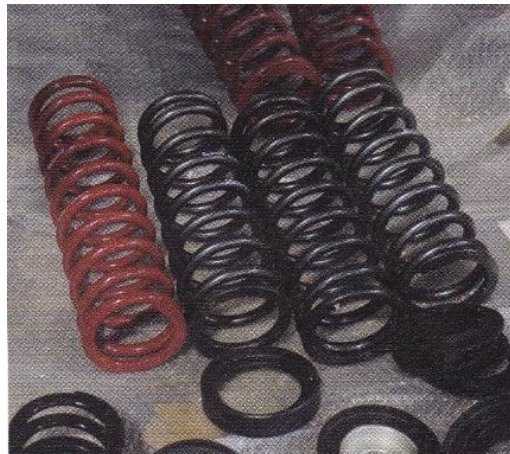
Figura 1. Muelles helicoidales (Esteban José Domínguez, Julián Ferrer: "Mecánica del vehículo" (2011)).
