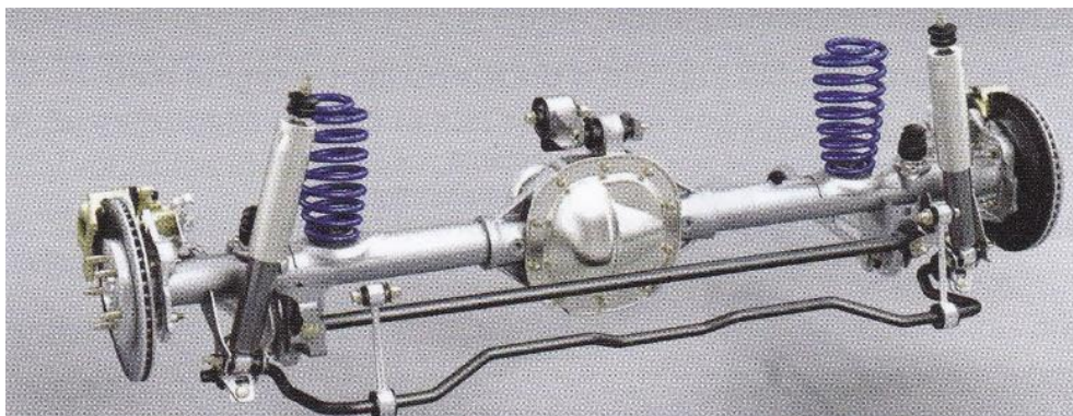
Figura 6. Montaje de la barra estabilizadora en un puente trasero rígido. (Esteban José Domínguez, Julián Ferrer: "Mecánica del vehículo" (2011)).
