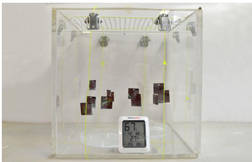
Figura 13. Sistema de exposición a envejecimiento mediante cámara de humedad. Autoría propia
