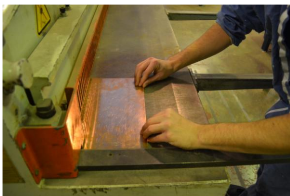
Figura 6. Corte de la plancha metálica mediante cizalla electromecánica. Autoría propia.
