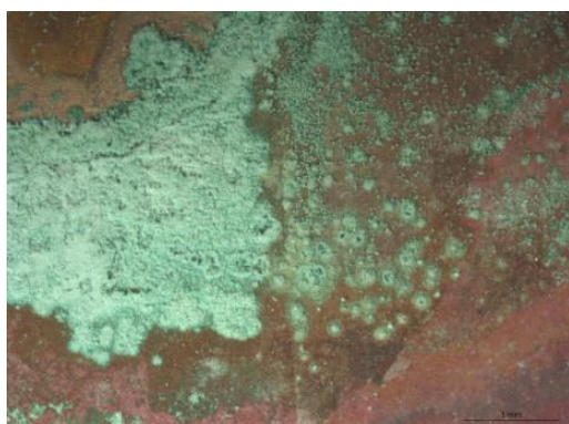
Figura 39. Superficie de la muestra AB3-E2 posterior al envejecimiento por humedad relativa. Donde se aprecia el efecto inhibitorio de la mitad de la muestra. Imagen al estereomicroscopio x10 Autoría propia.
