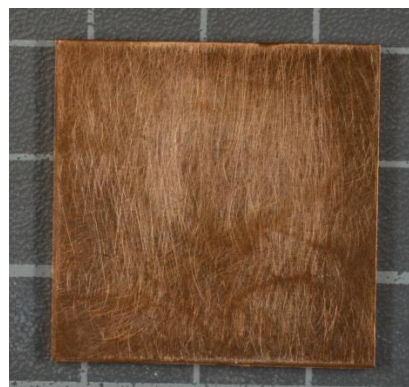
Figura 7. Probeta de bronce de referencia. Autoría propia.
