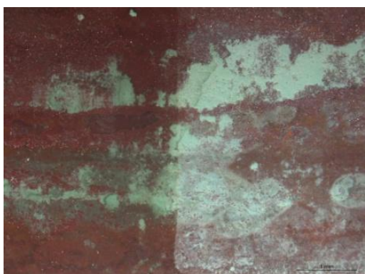
Figura 47. Muestra AB2-T1, se observa la zona protegida frente a la no protegida. Imagen al estereomicroscopio x10. Autoría propia.
