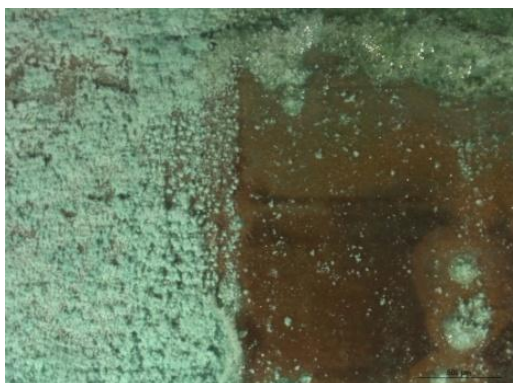
Figura 44. Superficie de la muestra AB3-T2 posterior al envejecimiento por humedad relativa. El efecto protector se hace patente. Imagen al estereomicroscopio x20. Autoría propia.
