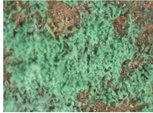
Figura 32. Observación del crecimiento de hidroxloruros sobre la cuprita a través del estereomicroscopio a 80x. Autoría propia
