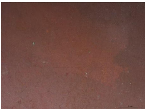
Figura 42. Detalle de una muestra B3-E2, tratada a la mitad con benzotriazol al 3%. Imagen al microscopio estereoscópico x10. Autoría propia.
