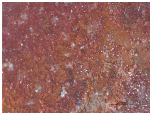
Figura 21. Estrato de cuprita observada por estereomicroscopio a 80x. Autoría propia.
