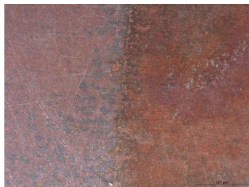
Figura 43. Detalle de una muestra AB1-E2, tratada a la mitad con BTA 3% + AMT 1%. Imagen al microscopio estereoscópico x25. Autoría propia.
