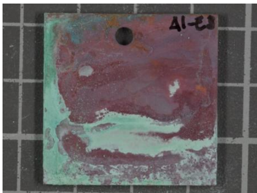
Figura 20. Probeta corroída artificialmente por cloruros. Autoría propia.
