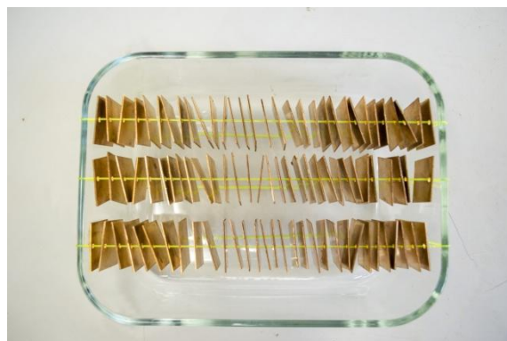
Figura 9. Mecanismo de suspensión de las probetas para el ensayo de envejecimiento por corrosión. Vista en planta. Autoría propia
