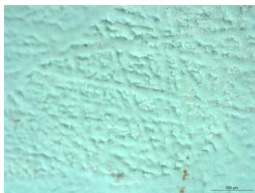
Figura 26. Observación del crecimiento de los hidroxiclорuros por medio de estereomicroscopio a 50x. Autoría propia
