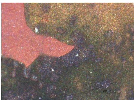
Figura 23. Pátina negra a través del estereomicroscopio a 80x. Autoría propia
