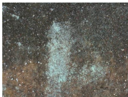
Figura 24. Observación de corrosión verde-grisácea a través del estereomicroscopio a 32x.
