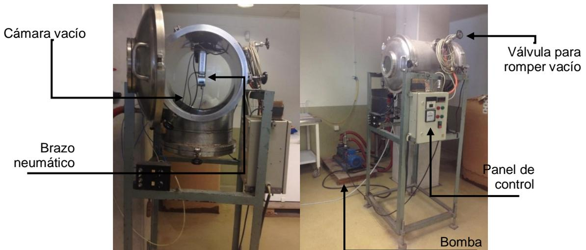
FIGURA 1. Equipo empleado en pruebas IV.
