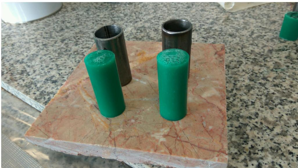
Figura 5.7: Cilindros de compresión antes de ser cortados a medida
