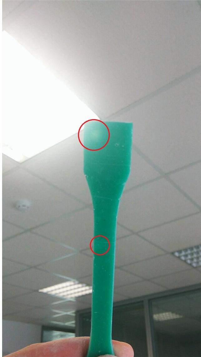
Figura 5.4: Probeta de tracción con defectos en forma de burbujas de aire retenidas. Indicadas con un círculo rojo
