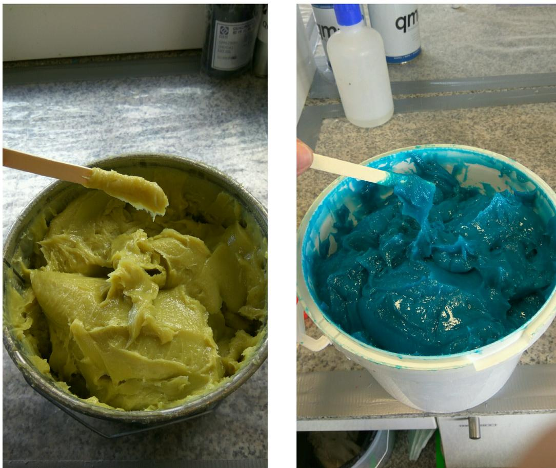
Figura 3.1: A la izquierda, parte **A** y a la derecha parte **B** del producto con alto contenido en espesantes
