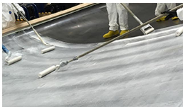
Figura 2.6: Aplicación de un producto EPOLIT® GC E en el molde de una pala de aerogenerador (Fuente: [www.aerox.es](http://www.aerox.es))
