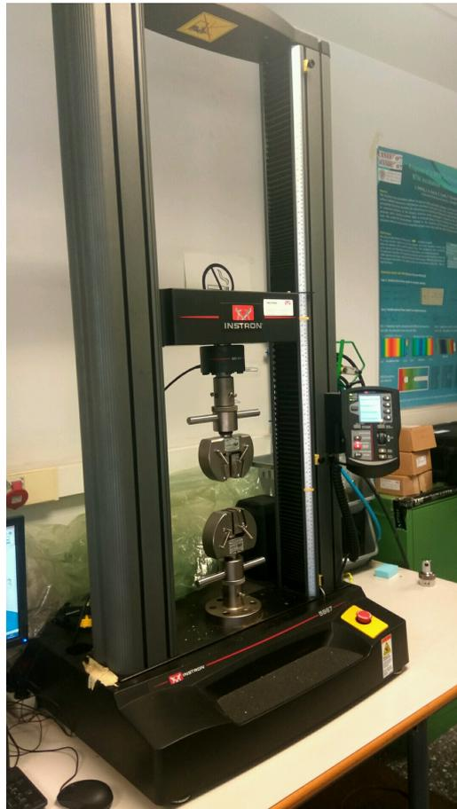
Figura 6.1: Máquina de ensayos universal asistida por ordenador.
