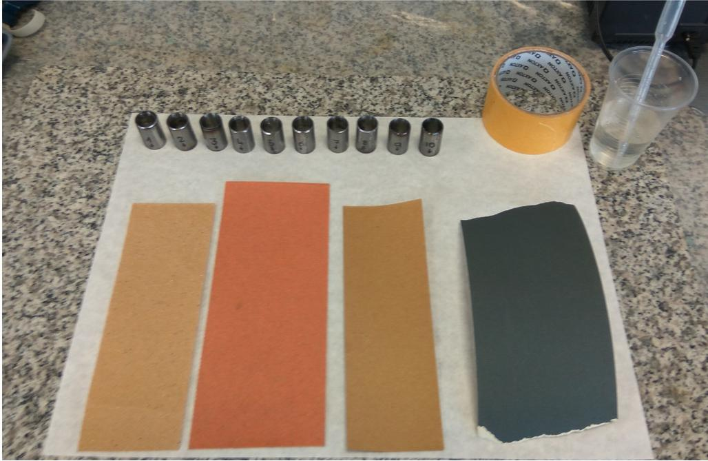
Figura 5.6: Moldes de compresión junto a las lijas utilizadas para su acabado
