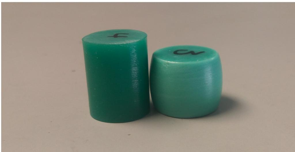
Figura 7.1: Comparativa entre probetas de compresión del producto N°1 antes y después del ensayo.
