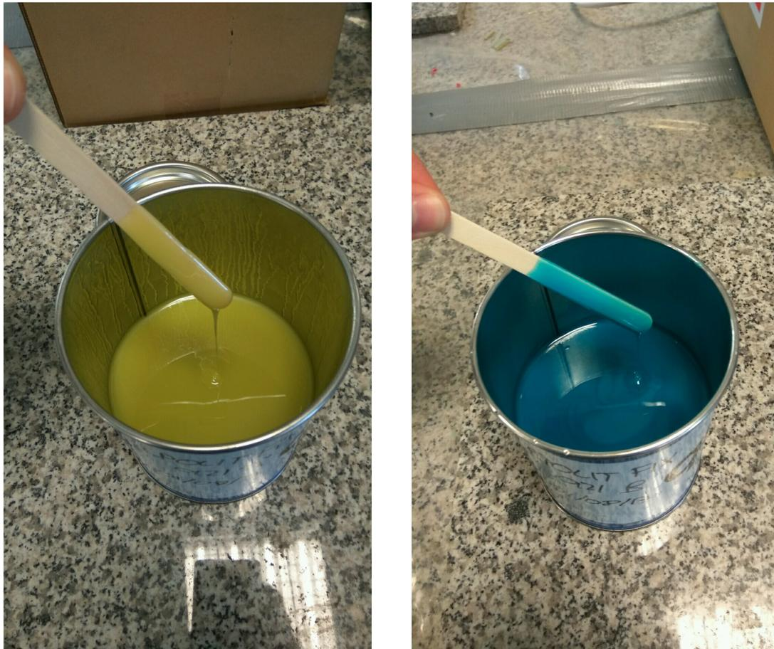
Figura 3.2: A la izquierda, parte **A** y a la derecha parte **B** del producto con bajo contenido en espesantes
