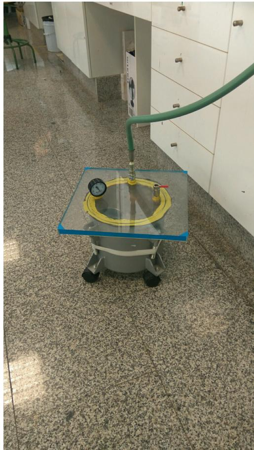
Figura 3.3: Cámara de vacío
