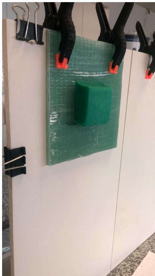
Figura 4.15: Muestra de SAG en durante el proceso de curado en un panel vertical
