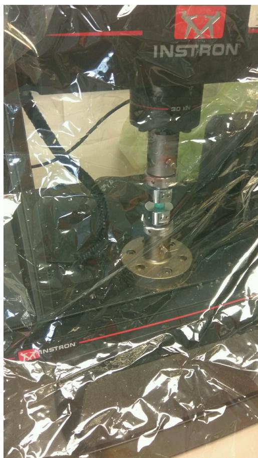
Figura 6.6: Mampara de seguridad en el ensayo de compresión.
