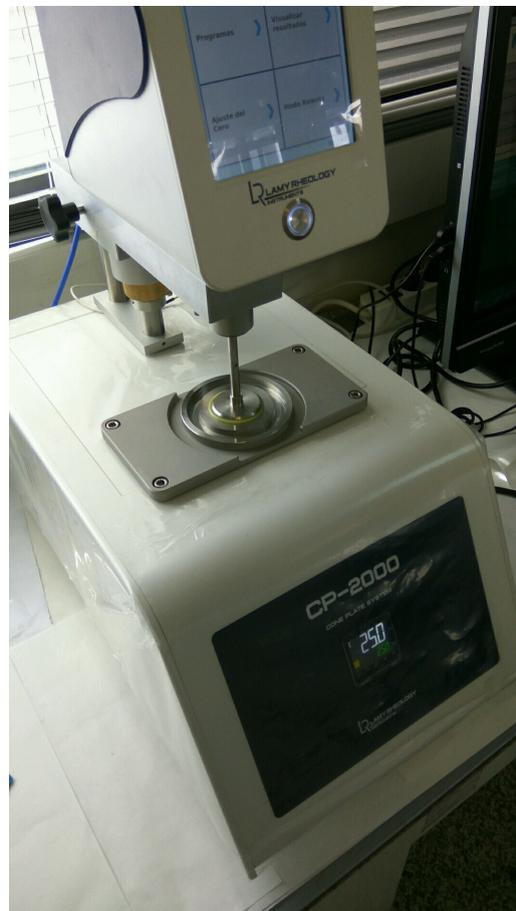
Figura 4.2: Control de la viscosidad de la parte A del producto
