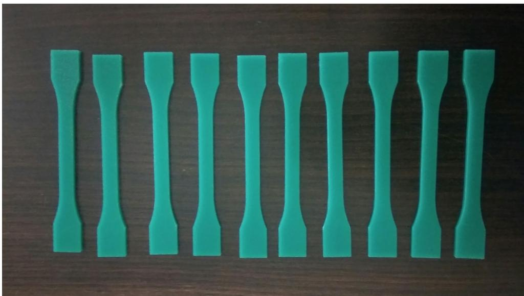
Figura 5.5: Resultado final de las probetas de tracción
