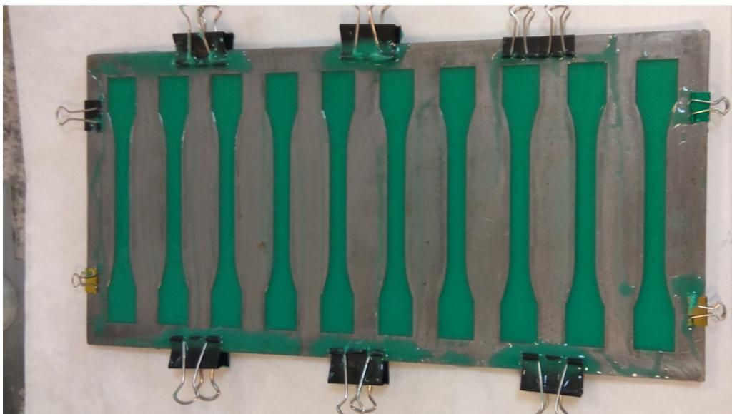
Figura 5.3: Probetas de tracción antes del proceso de curado.
