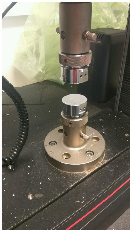
Figura 6.5: Útiles de compresión acoplados a la máquina de ensayos.
