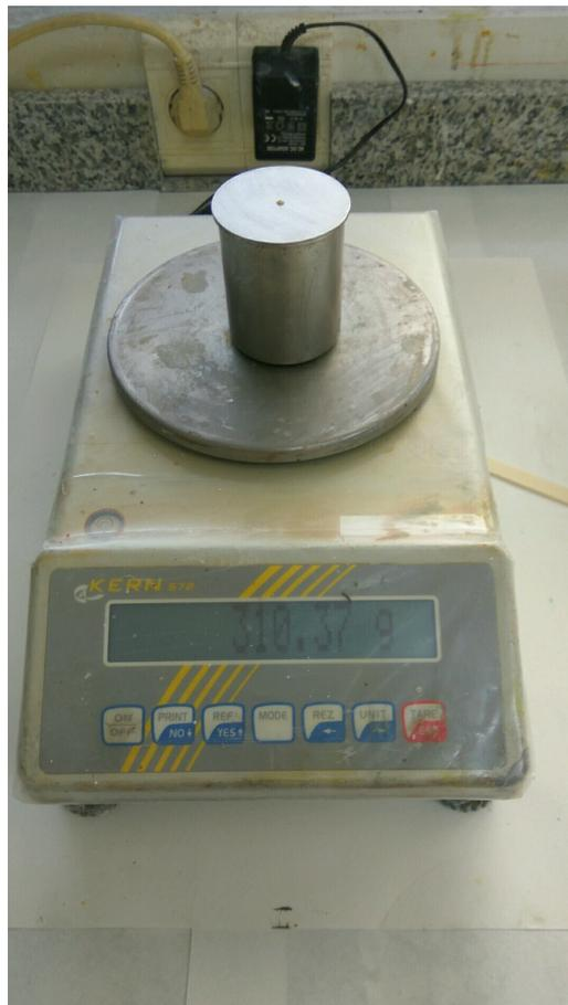
Figura 4.4: Medición de la masa del picnómetro lleno de producto
