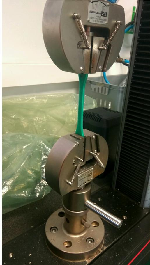
Figura 6.3: Posición correcta de la probeta para ser ensayada.
