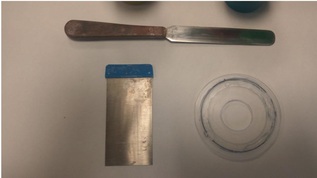
Figura 4.1: Instrumentos auxiliares para el control de viscosidad
