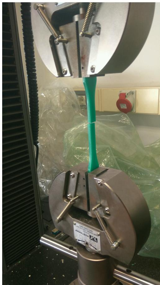
Figura 6.4: Ensayo de tracción finalizado.
