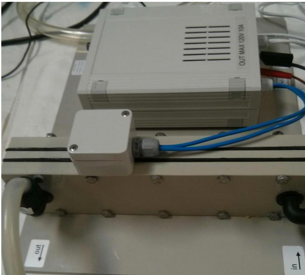
Figura 6. Reactor BDD con polarización y 3 electrodos de diamante con área total de 126 cm<sup>2</sup>
