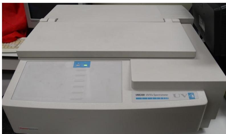
Figura 9. Espectrofotómetro UV/Vis UV 4 de ThermoSpectronic
