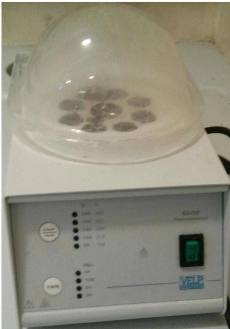
*Figura 10. Digestor ECO 8 de Velp Scientifica*
