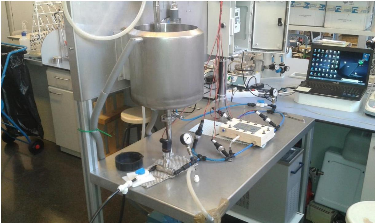
Ilustración 8. Planta de Ultrafiltración utilizada.
