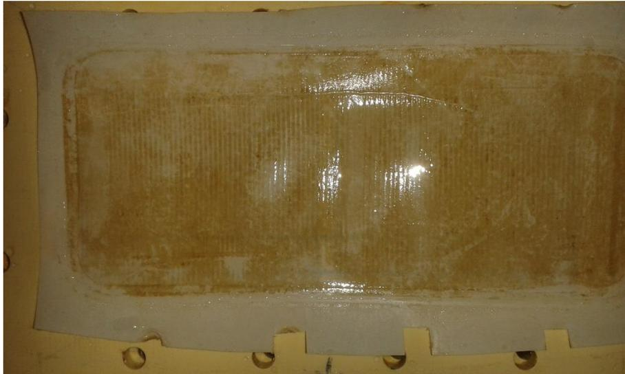
Ilustración 10. Membrana de UF al finalizar todos los experimentos.
