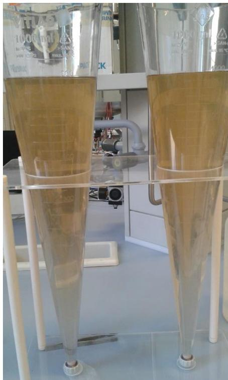
Ilustración 13. Conos Imhoff para la obtención de sólidos en suspensión.
