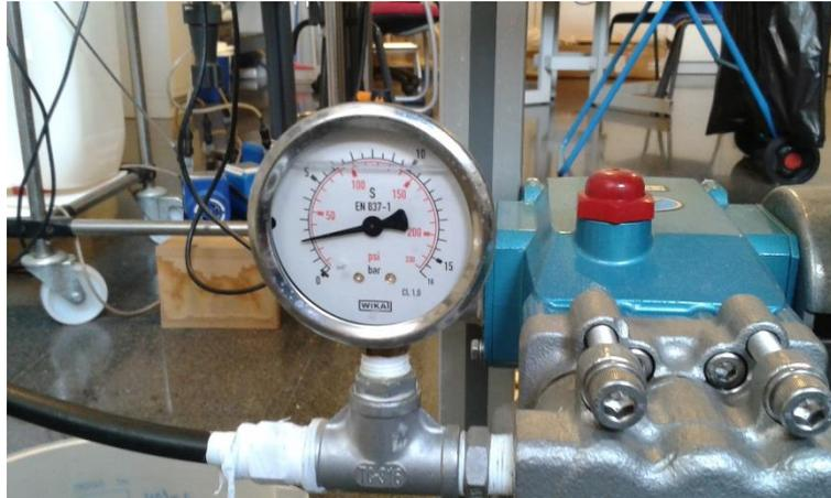
Ilustración 16. Manómetro utilizado en el presente trabajo.
