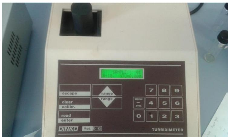
Ilustración 20. Turbidímetro utilizado en el presente trabajo.
