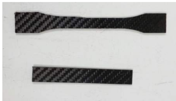
Figura 3.27: Arriba probeta de tracción. Abajo probeta de flexión
