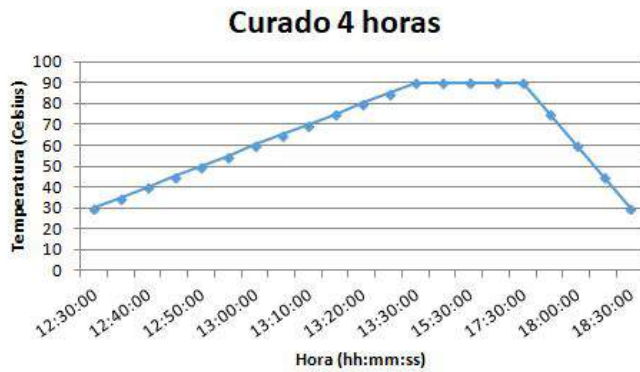
Figura 3.22: Rampa de curado de 4 horas
