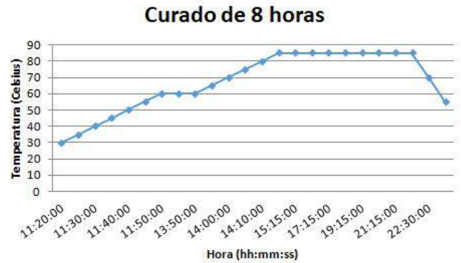
Figura 3.23: Rampa de curado de 8 horas
