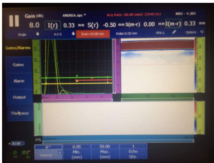
Figura 4.50: Parámetros a variar en el sub-menú Thickness
