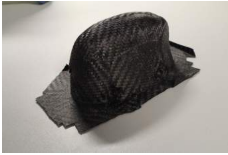
Figura 3.17: Canopy después de la fabricación
