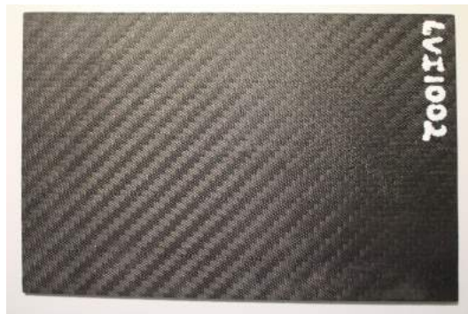
Figura 4.1: Placa con un daño no visible
