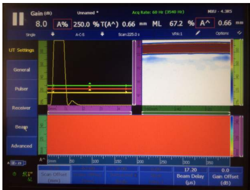
Figura 4.38: Parámetros a variar en el sub-menú Beam
