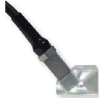
Figura 3.33: Palpador con ángulo de haz distinto de cero y cuña inclinada
