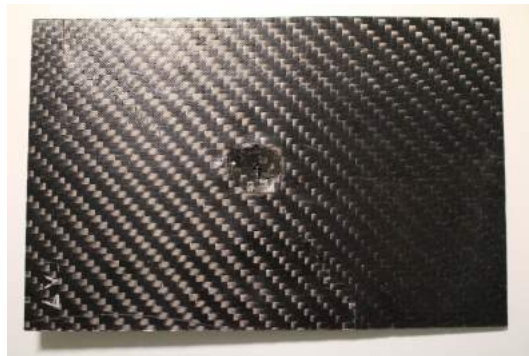
Figura 4.3: Placa con daño visible por dos caras
