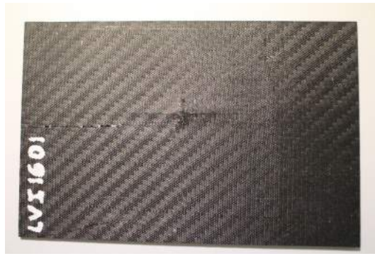
Figura 4.2: Placa con daño visible por una cara
