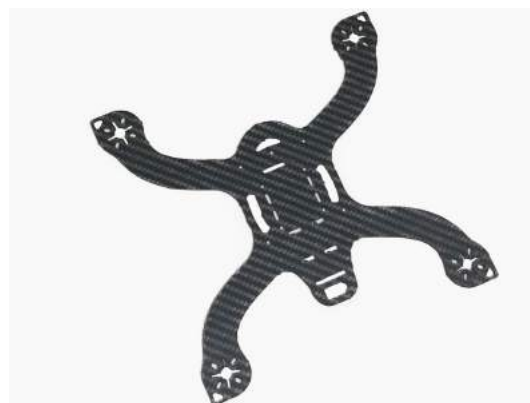
Figura 3.21: Frame obtenido después del mecanizado
