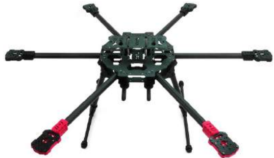
Figura 5.2: Drone con brazos cilíndricos
