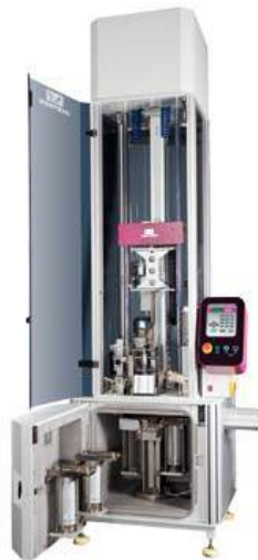
Figura 3.28: Máquina para el ensayo de impacto
