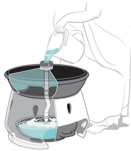
Figura 48: Ilustración del funcionamiento de Eliodoméstico.
