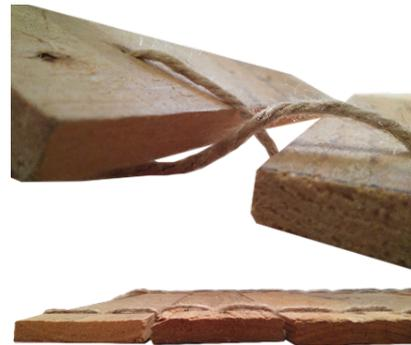
Figura 138: Proceso de paso de la cuerda.
