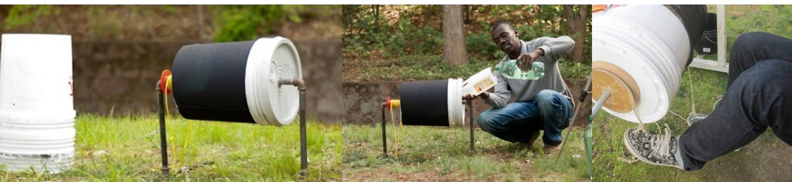
Figura 61: La lavadora Up-Stream. / Figura 62: Modo de preparación del lavado de Up-Stream. / Figura 63: Pedaleo para el lavado de Up-Stream.
