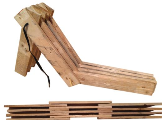
Figura 90: Prototipado con las tablas del pale y cuerda de la opción 1.4.
