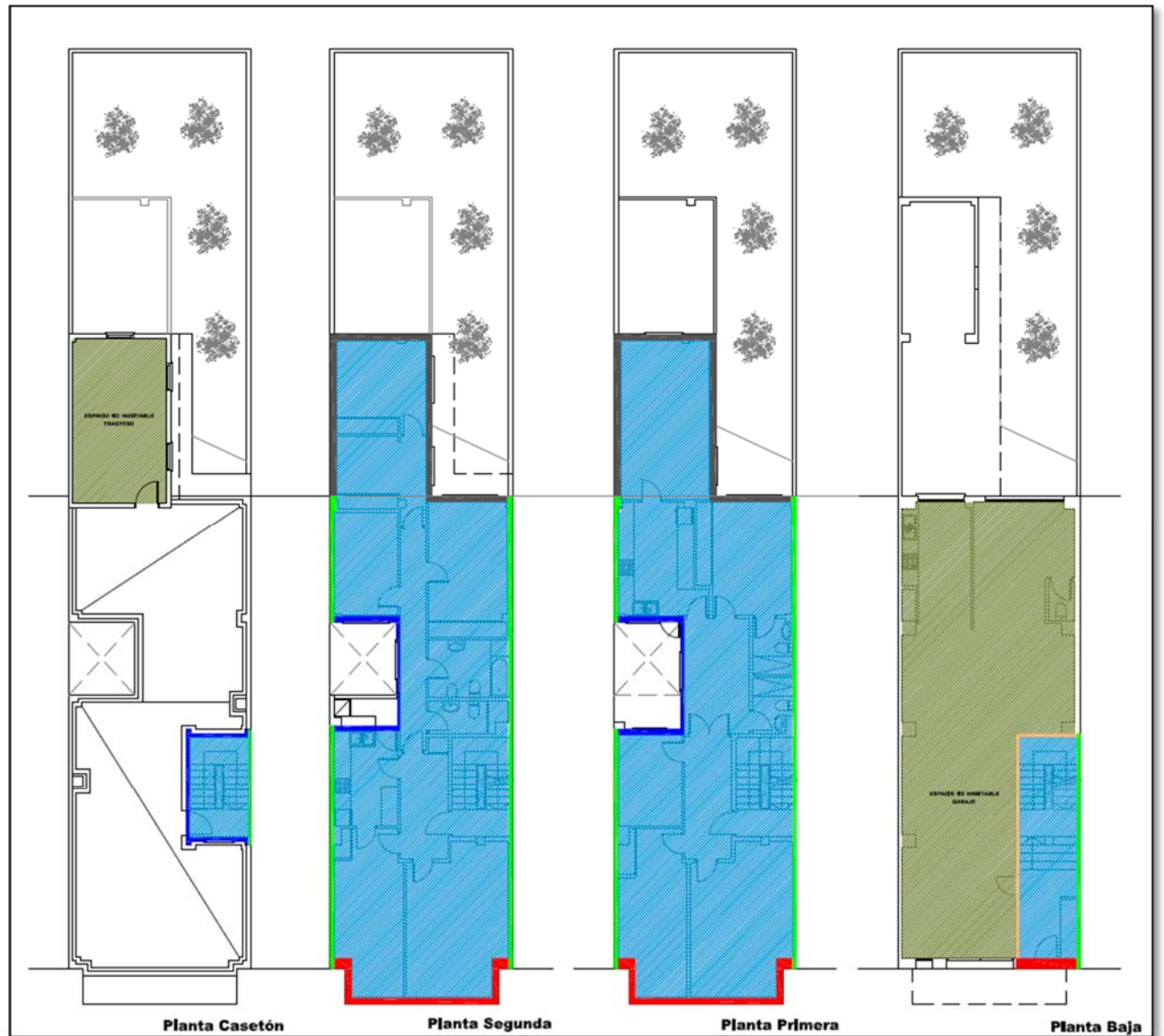
Figura 61. Esquema zonas habitables-no habitables y tipos cerramientos. Año 2017. Fuente propia. Sin escala.
