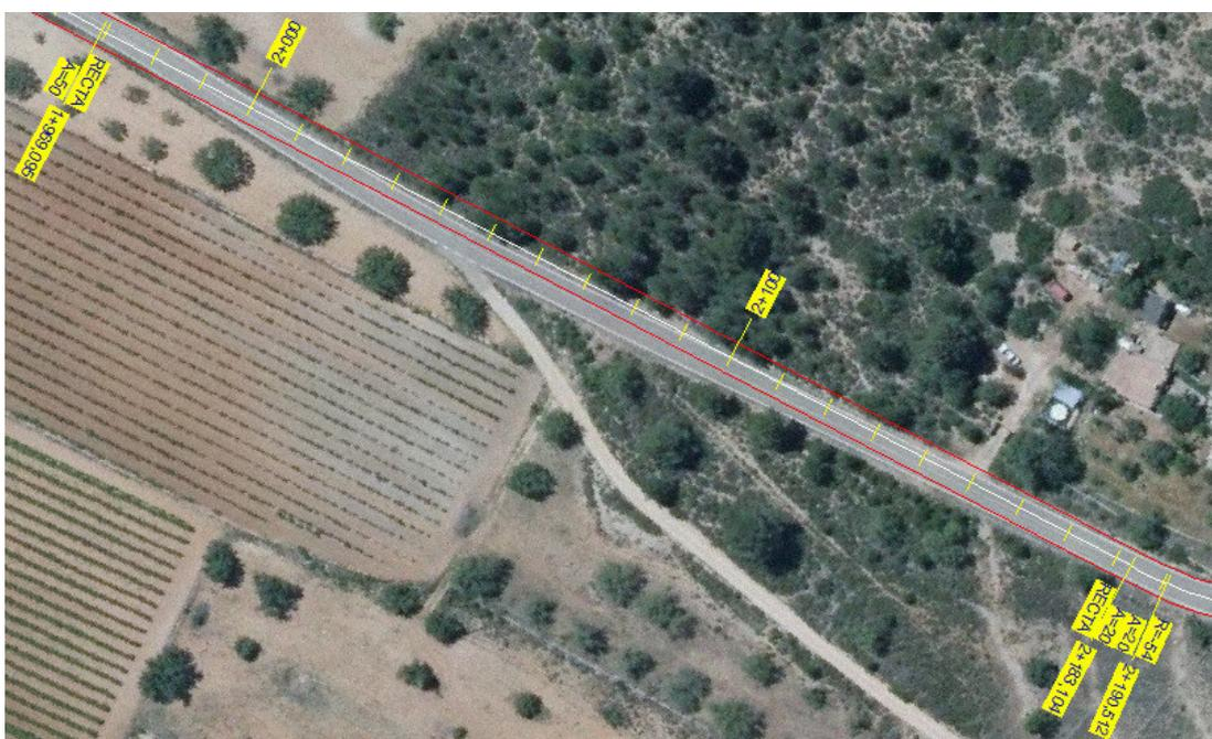
P.K. 2+426,995: ampliación del radio de la curva circular a 30 m.
