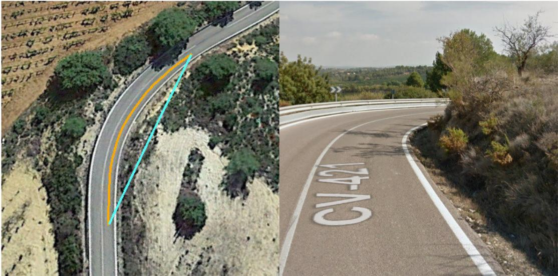
Para este cálculo:  $V = 40 \text{ km/h}$ ;  $f_i = 0,432$ ;  $i = -1,161/100$ ;  $t_p = 2 \text{ s}$ .
