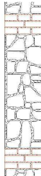
Figura 29: Detalle muro de mampostería. 2016. Fuente Propia
