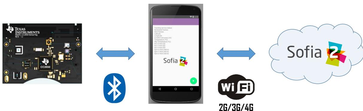
Figura 33. Esquema de conectividad de los dispositivos
