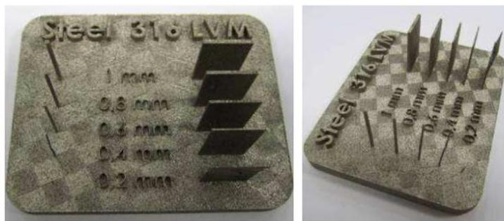
Fig.18. Placa de ensayos de detalles de distinto tamaño
