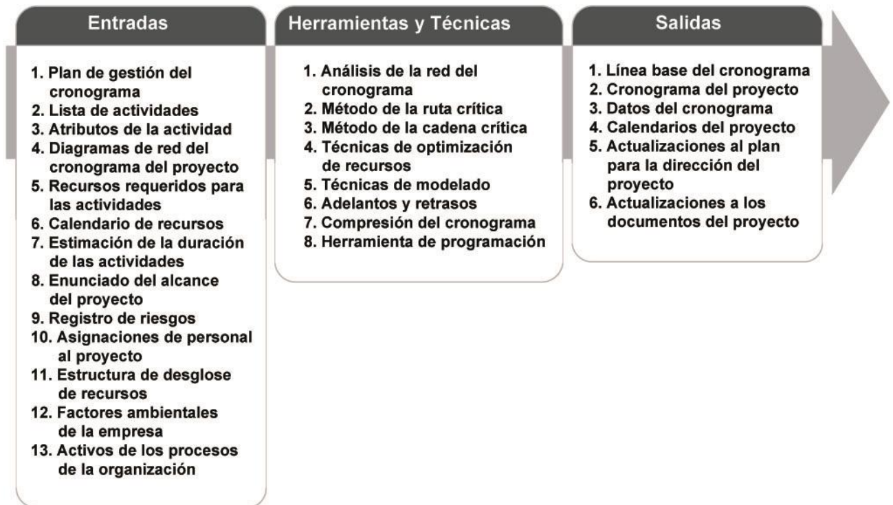
Figura 26: Desarrollar el Cronograma: Entradas, Herramientas y Técnicas, y Salidas. Entradas, Herramientas y Técnicas, y Salidas. Elaboración propia a partir de la fuente: (Project Management Institute, 2013)
