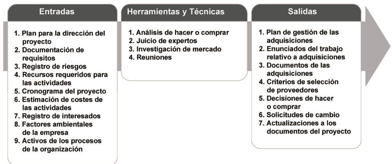
Figura 52: Planificar la Gestión de las Adquisiciones: Entradas, Herramientas y Técnicas, y Salidas. Elaboración propia a partir de la fuente: (Project Management Institute, 2013)
