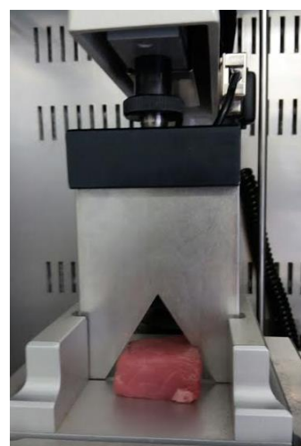
Figura 3.8. Test de cizalla con la sonda Warner Blatzler Blade V.
