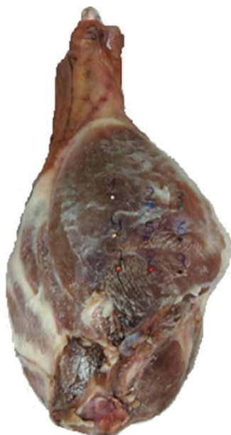
Figura 3.3. Puntos establecidos en la maza del jamón para las medidas ultrasónicas.
