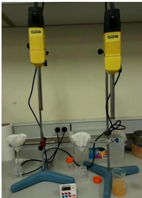
Figura 3.11. Montaje para el disgregado y filtrado de la muestra.
