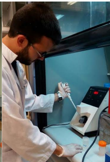
Figura 3.12. Análisis de cloruros. Introducción de la alícuota de muestra.
