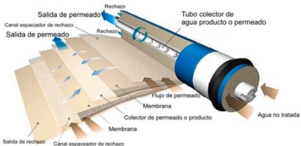
Figura 3.12: configuración en espiral de membranas planas
