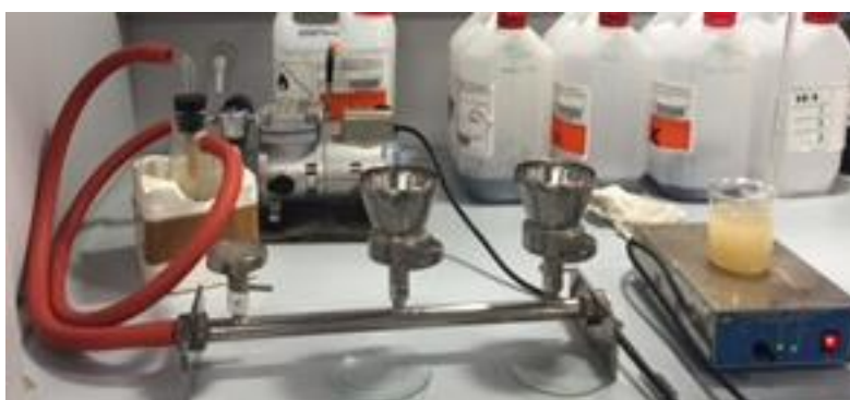
Figura 4.16 Montaje del equipo de filtración a vacío.
