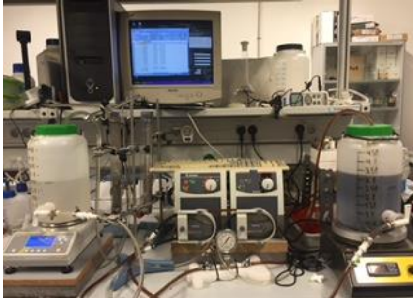
Figura 5.2 Sistema de Osmosis directa utilizado.
