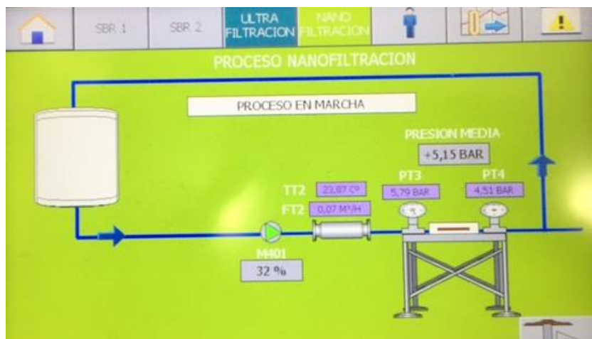
Figura 4.13. Panel de control digital planta nanofiltracion 2
