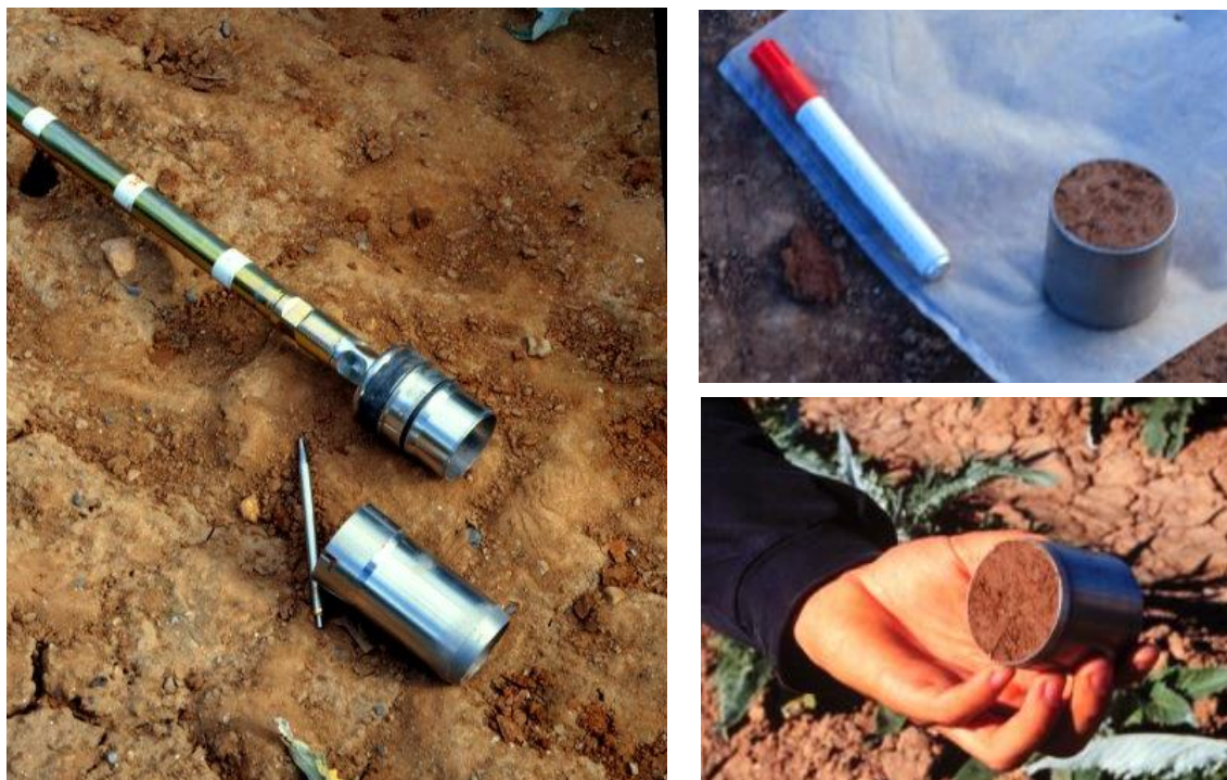
Figura 16. Barrena utilizada para obtener muestras inalteradas (izquierda) y la muestra de suelo obtenida (derecha).
