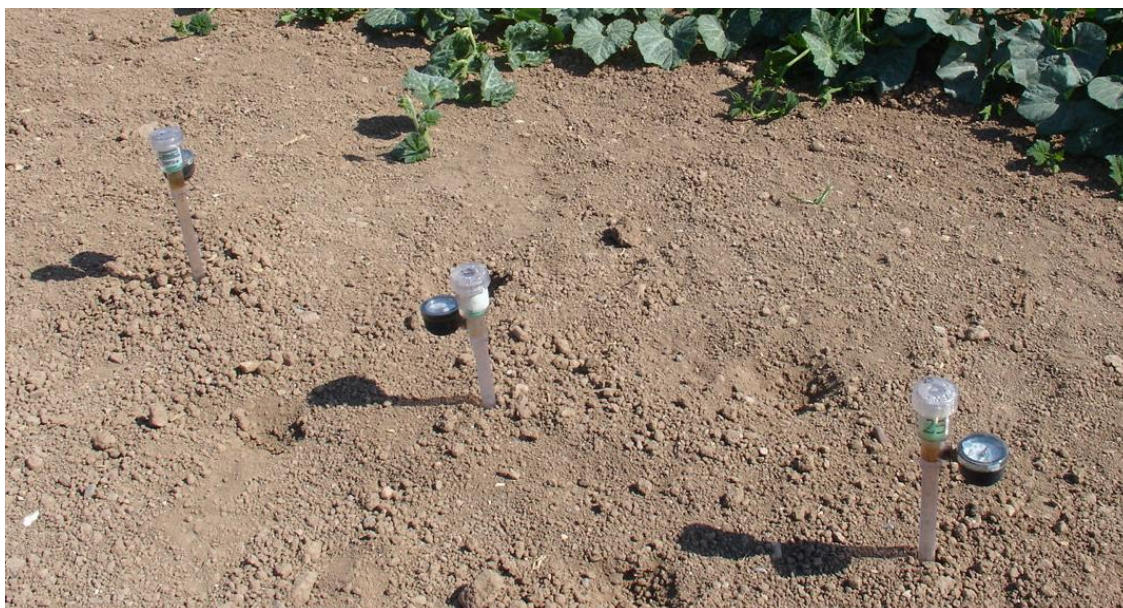
Figura 12. Tensiómetros instalados en la parcela Paterna 1, en la zona central de la bancada de cultivo.
