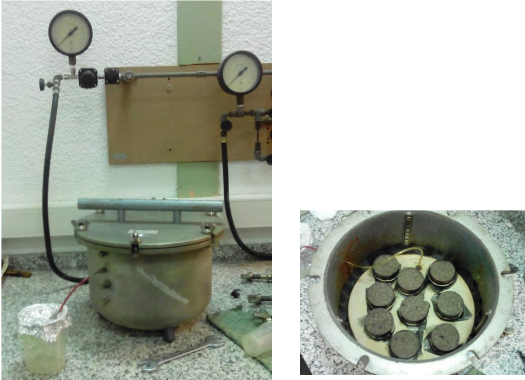
Figura 17. Equipo de placas de presión utilizado (Laboratorio de suelos de la ETSMRE-UPV)
