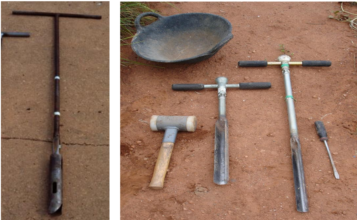
Figura 11. Tipos de barrenas utilizados: Barrena tipo Riverside (izquierda). Barrenas de percusión (derecha).
