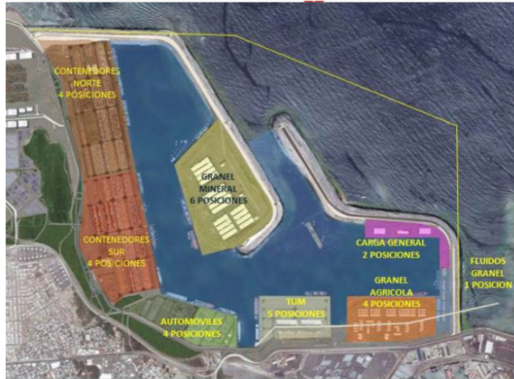
Figura 4.2: Terminales contempladas en la Ampliación
