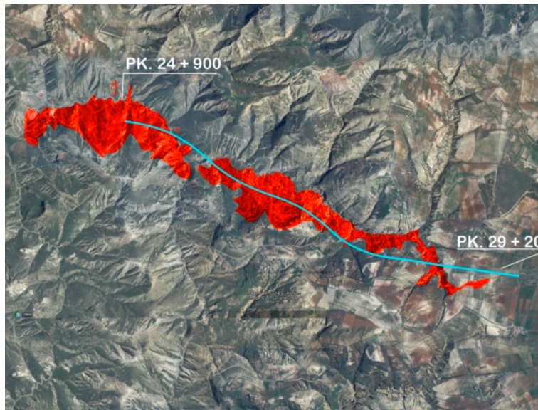
Fig 3. Zona de inestabilidad del terreno. Fuente: LIC
