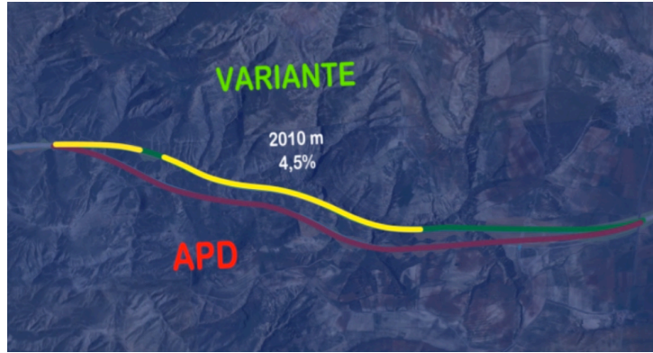
Fig 9. Comparación entre la proposición inicial (APD) y la variante finalmente ejecutada.. Fuente: LIC
