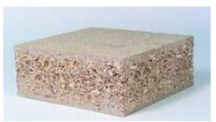
Figure 15: Sample of flax-board <u>www.bm-online.de</u>, BM-Marktübersicht: Moderne Leichtbauwerkstoffe (2005)
