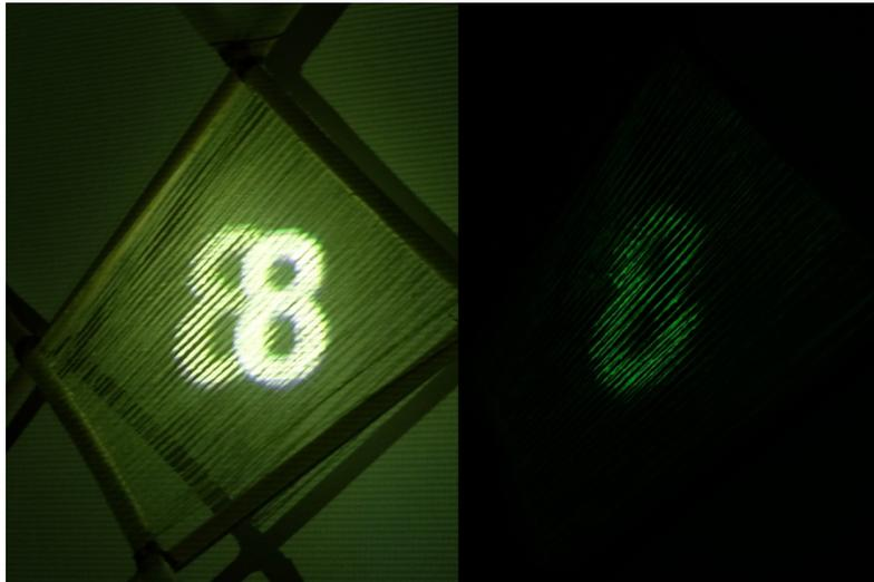
Fig. 15. Prototipo cuerda y pintura luminiscente.
