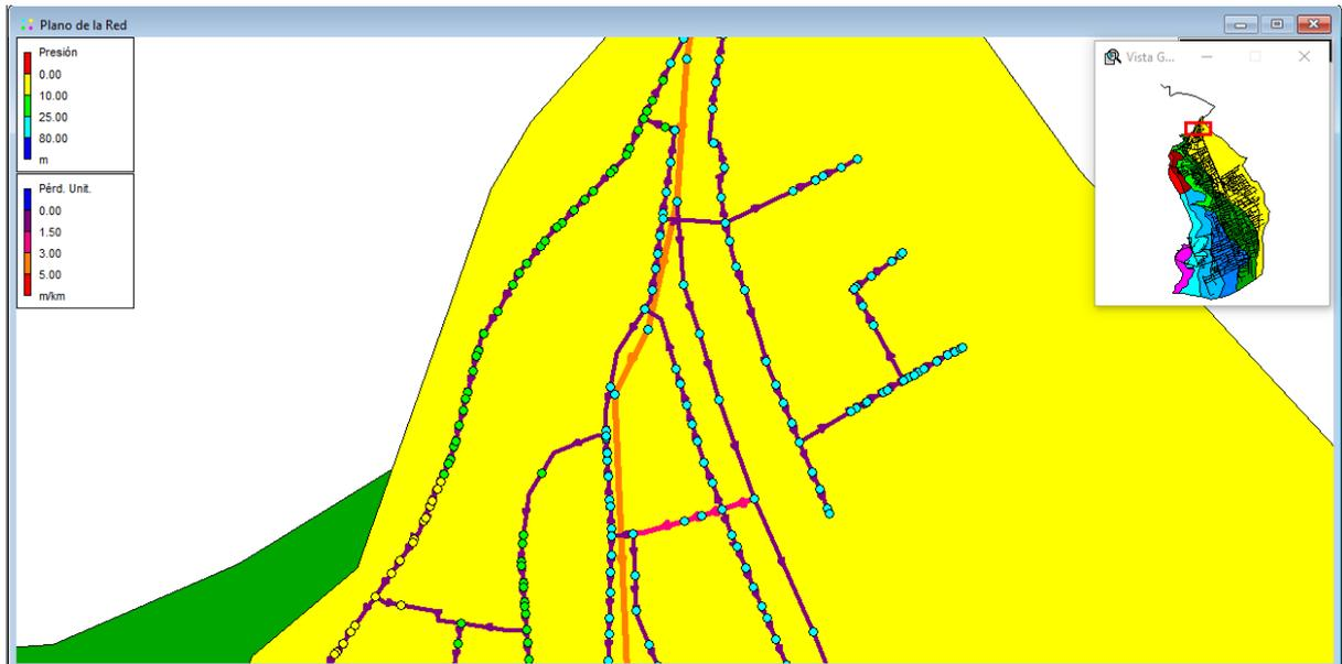
Ilustración 23 Pérdidas unitarias en Línea de Conducción y bajas presiones en zonas altas del Sector 1 ZP-1
