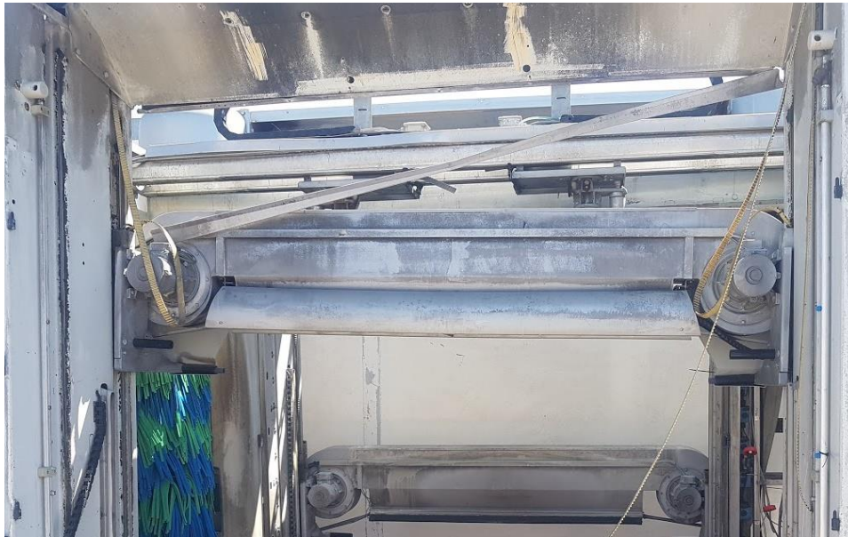
Ilustración 80. Grupo secado sujeto por sistema enclavamiento.
