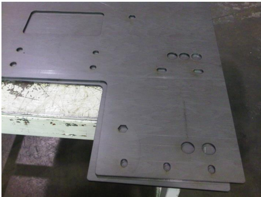
Ilustración 18. Piezas sin acabar cortadas por láser
