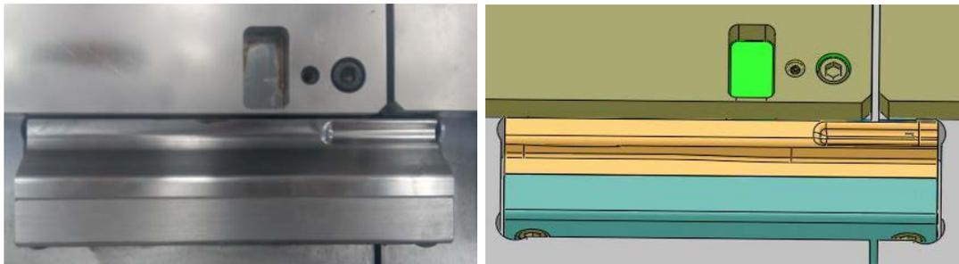
Figura 71 Detalle del montaje del punzón doblador del ala.
