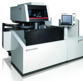
*Figura 56 Máquina de electroerosión por hilo*
