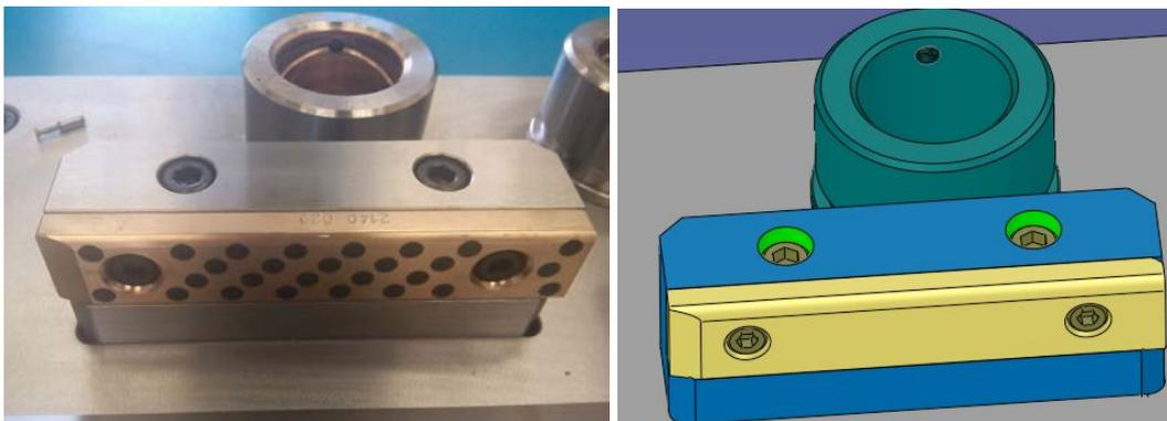
*Figura 67 Detalle del montaje del taco de reacción*
