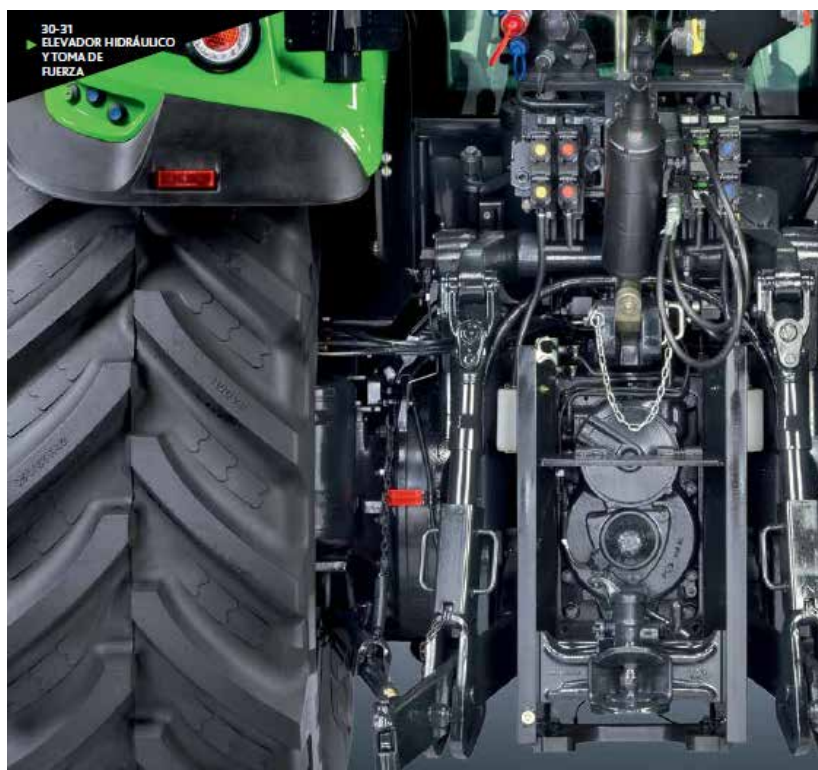
Fotografía 18: Punto de enganche y distribuidores, Deutz-Fahr, serie 6
