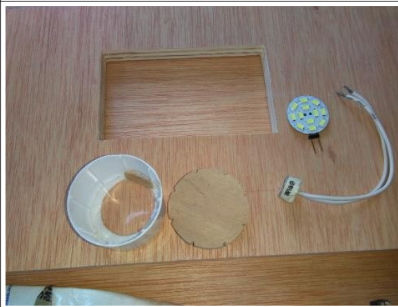
Aislamos el led para protegerlo de la humedad con un tapón de plástico y un pequeño tapón de madera fabricado y moldeado artesanalmente.
