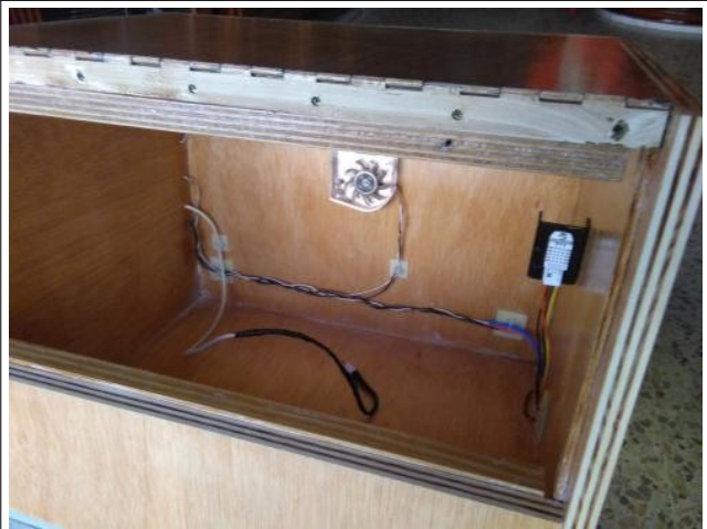
Instalamos la bisagra de la puerta
