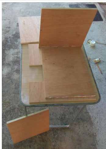
Encolado de los tableros de contrachapado
