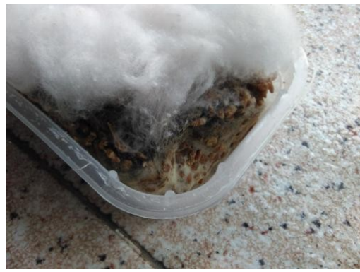
Muestra reseca por exceso de caudal de aire
