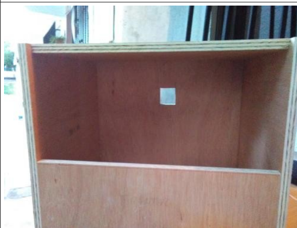
Agujero realizado en la parte posterior de la caja a medida de la peltier, donde irá encajonada la misma
