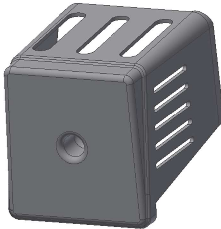
Figura 3.32 Cubierta del carburador finalizada
