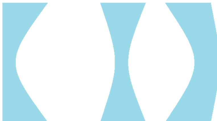
Fig. 14 Lentes planocóncava (izquierda), bicóncava (centro), convexo cóncava (derecha)
