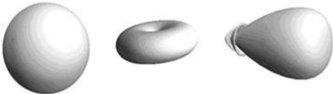
Fig. 9 Diagramas de radiación en 3D isotrópico (izquierda), omnidireccional (centro) y directivo (derecha)
