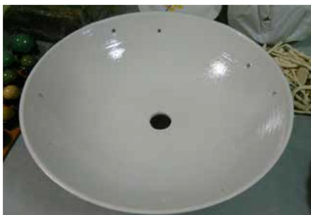
Figura 227 - Aplicación del vidriado
