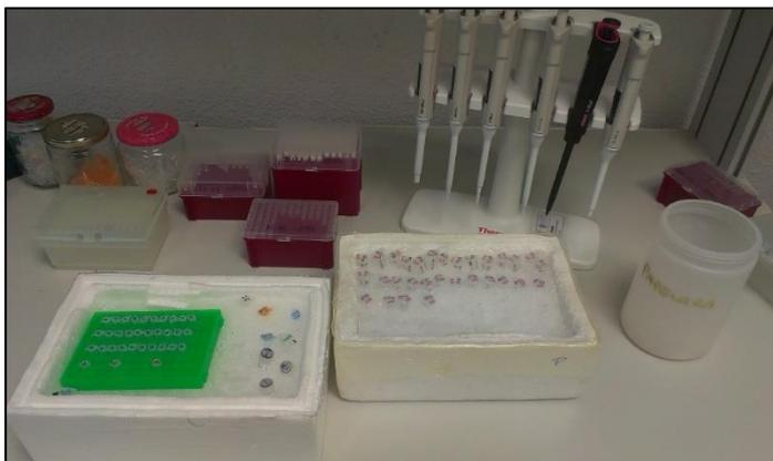
**Figura 8.** Detalle de los tubos eppendorf de 1,5 ml con el ARN extraído de las muestras y tubos de 0,2 ml donde se mezcla este ARN con el cóctel de reacción para la realización de la RT-PCR, todo sobre hielo picado.
