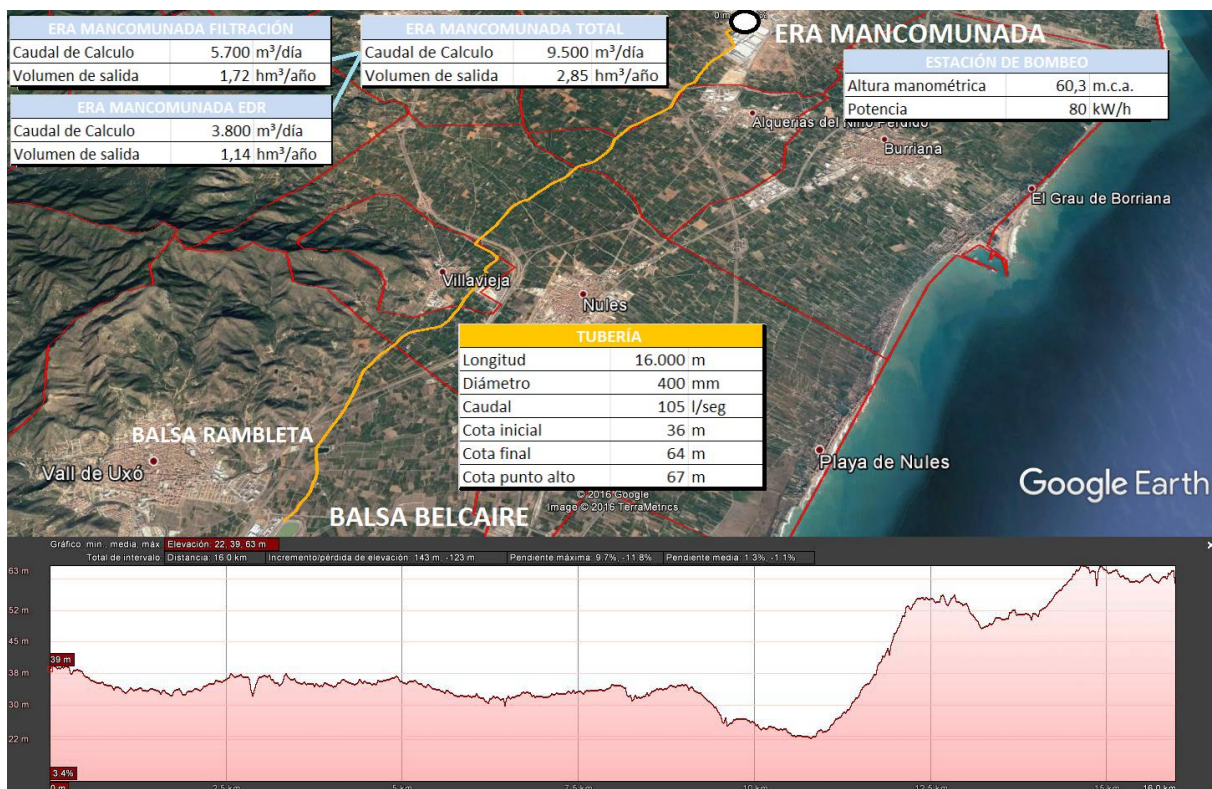
Figura 37. Esquema y datos principales de la reutilización EDAR Mancomunada.
