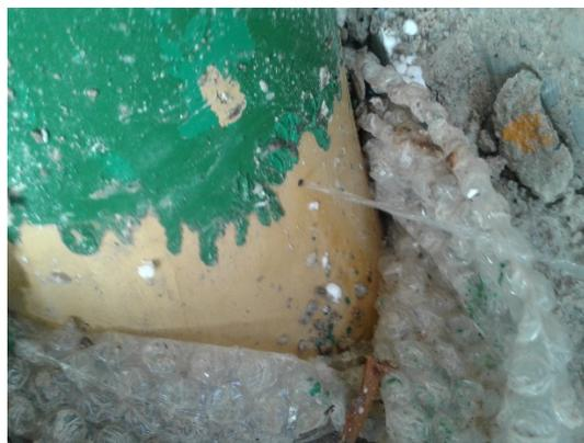
*Ilustración 36. Picadura en tubería de fundición*
