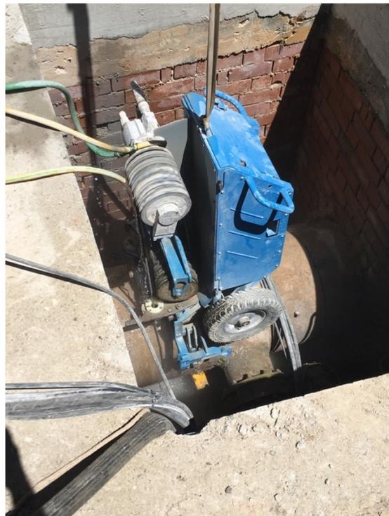
*Ilustración 82. Cortadora de hilo de diamante*
