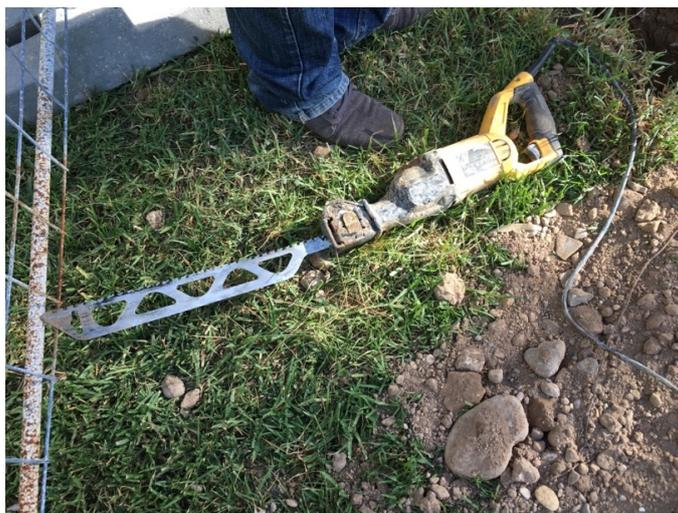
Ilustración 67. Sierra eléctrica de sable
