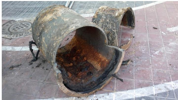
*Ilustración 11. Tubería de fundición gris retirada donde se puede comprobar las incrustaciones de sulfato de hierro*
