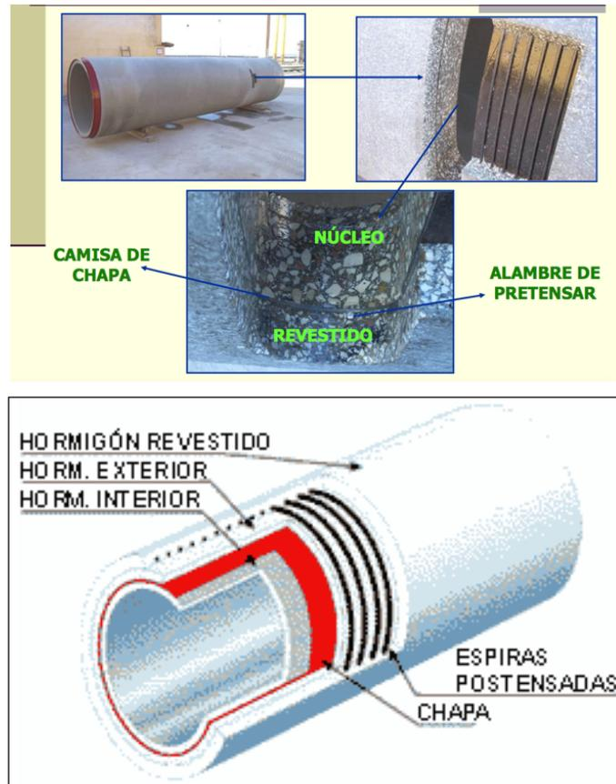
Ilustración 23. Detalle de tubería de hormigón postensado con camisa de chapa
