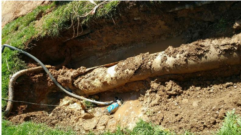
*Ilustración 35. Reventón de una tubería de fibrocemento*
