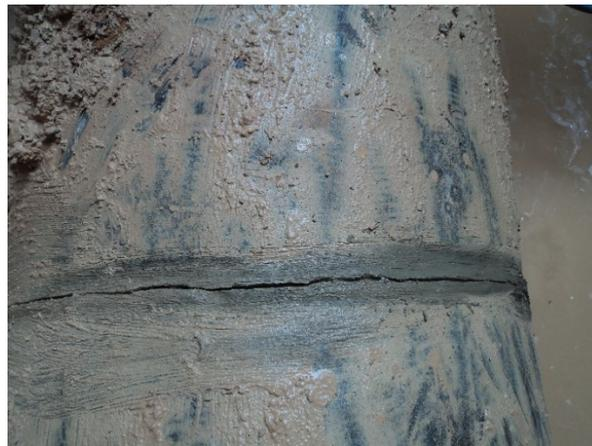
*Ilustración 33. Tronchado en tubería de fundición*
