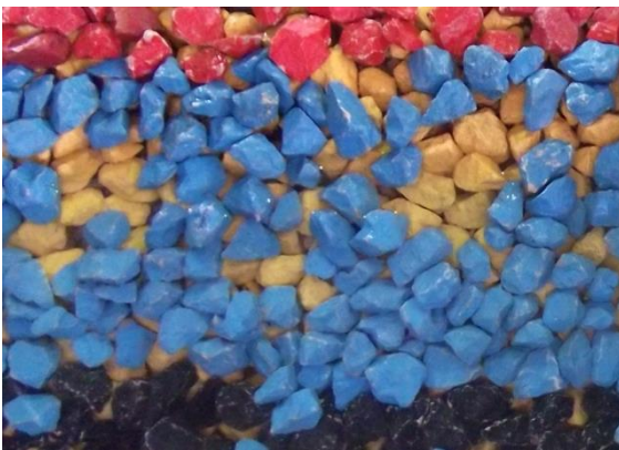
Figura 3. 10. Ejemplo de Inicio de Avería de Iribarren en manto bicapa de escollera.
