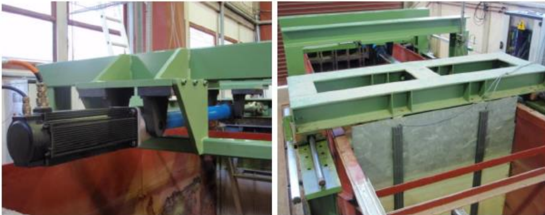
Figura 5. 2. Vista trasera y delantera del sistema generador de oleaje.
