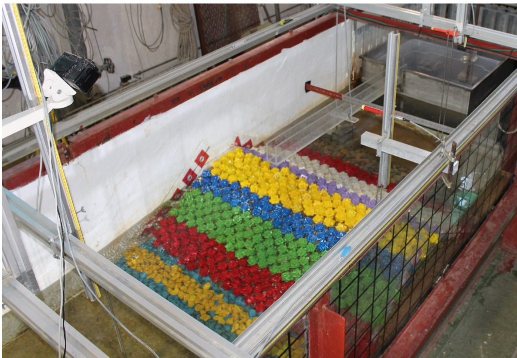
Figura 5. 25. Resultado final tras colocación del manto.
