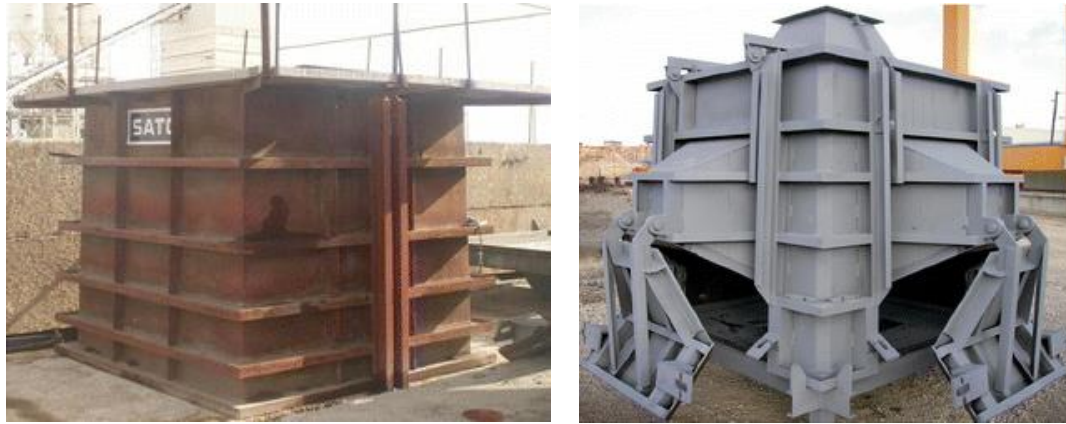
Figura 2. 11. Comparación entre el encofrado de cubos y Cubipodos.
