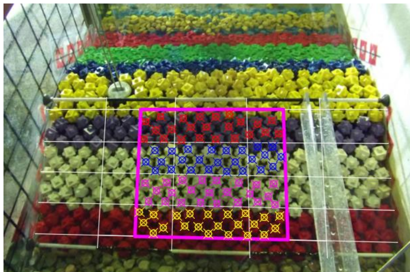
Figura 5. 32. Malla virtual sobre el trasdós del manto principal del modelo y conteo de las piezas en AutoCAD para el cálculo del daño adimensional equivalente.
