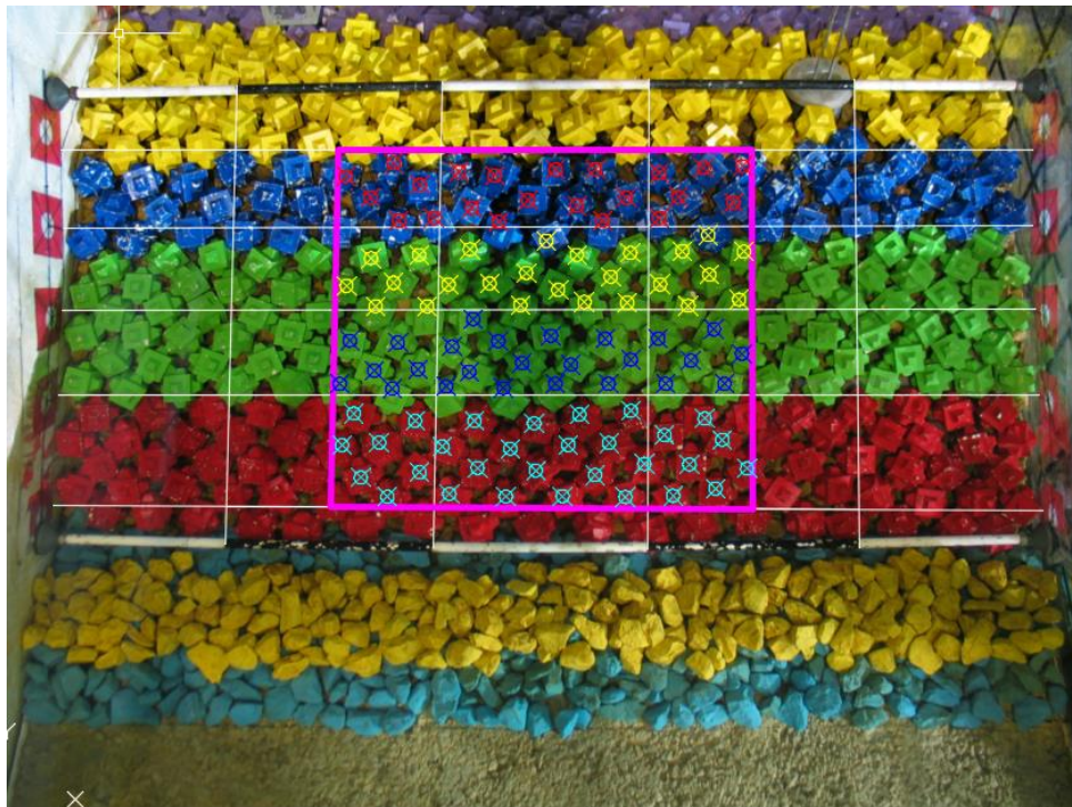
Figura 5. 16. Ejemplo de definición de las cuadrículas para el cálculo de la porosidad.
