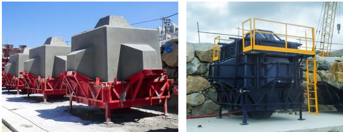
Figura 2. 10. Base y encofrado superior articulado de Cubípedo.
