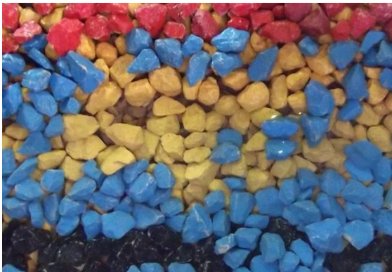
Figura 3. 11. Ejemplo de Inicio de Destrucción en manto bicapa de escollera.
