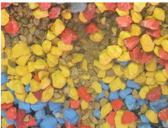
Figura 3. 12. Ejemplo de Destrucción en manto bicapa de escollera.
