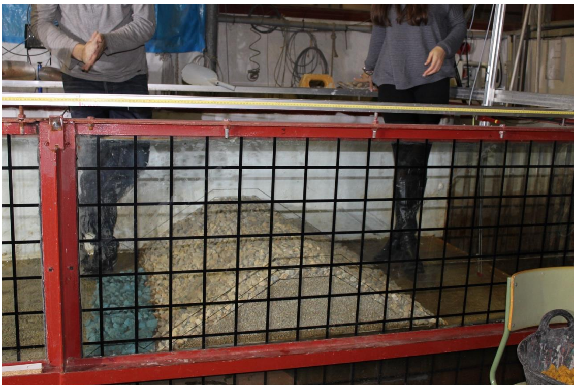
Figura 5. 24. Colocación de la berma.
