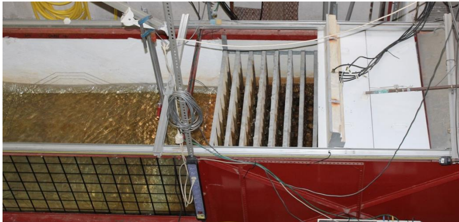
Figura 5. 3. Sistema de disipación de energía (parcialmente tapado).
