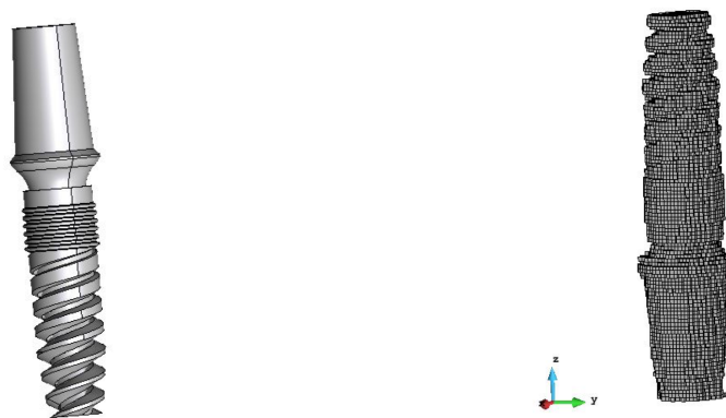
Figura 57.- Modelo CAD del implante (izquierda) y malla cartesiana del mismo (derecha)
