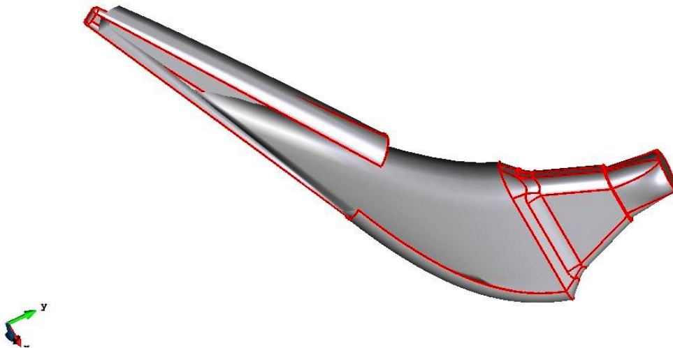
Figura 26.- Error de definición de la geometría de la geometría de la pieza al tratar de reparar la geometría
